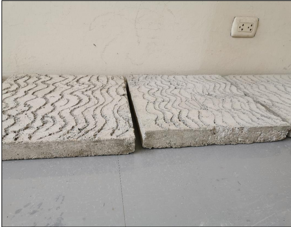
Figura N° 31. Base de concreto para ensayo de adherencia
