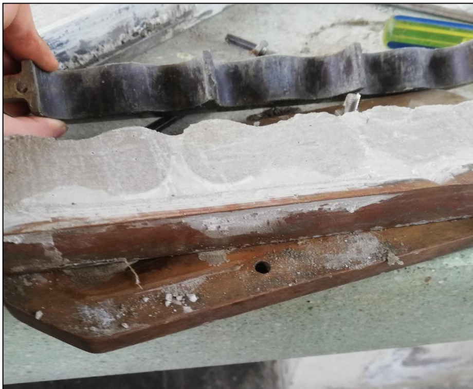
Figura N° 28. Desencofrado de mortero para ensayo de tensión
