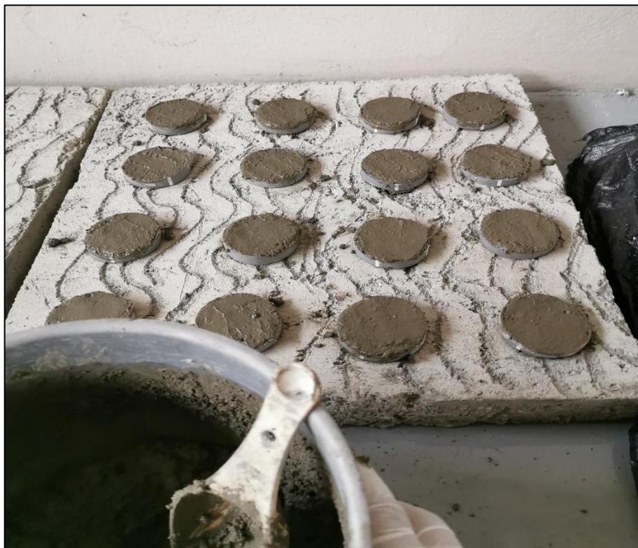
Figura N° 32. Colocación de pastillas de mortero
