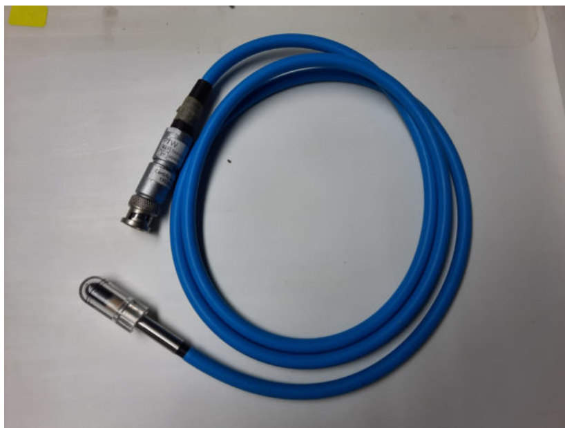
Figura 3.2: Cámara de ionización Semiflex 31010, utilizado para las medidas de dosis relativa.
