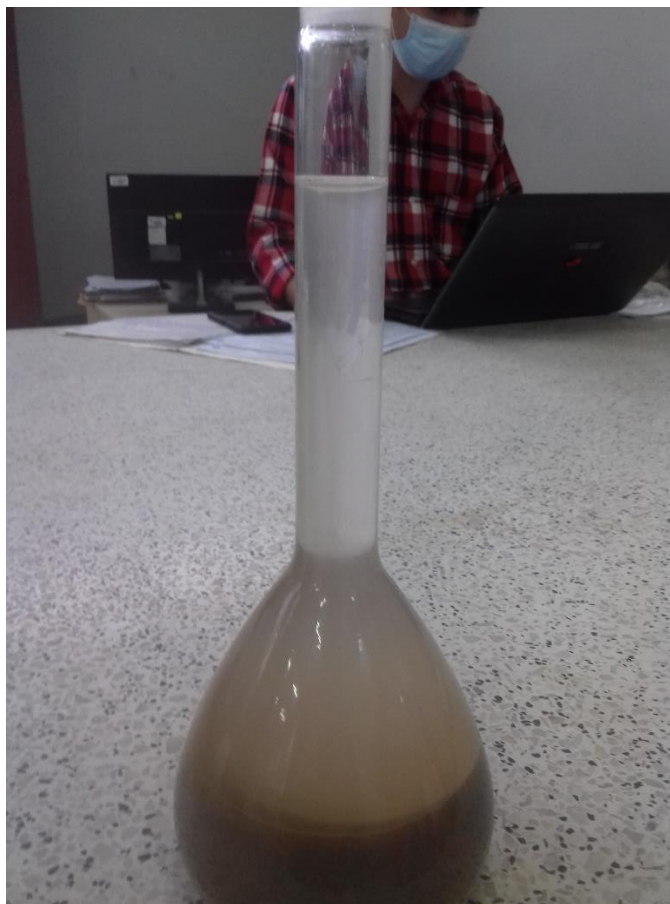
Fotografía 3 Muestra de agregado fino para ensayo de peso específico
