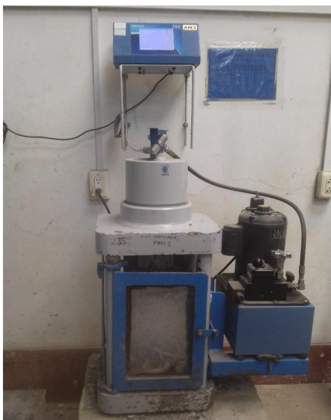
Fotografía 10 Muestra de concreto para ensayo de resistencia a la compresión
