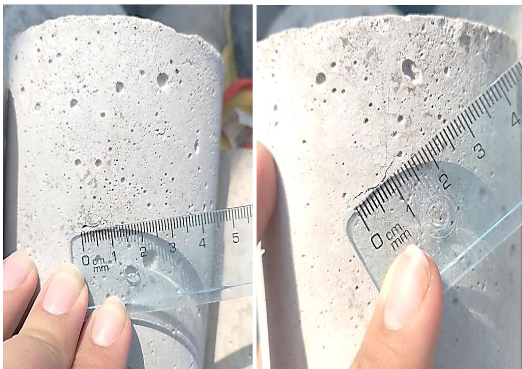
Figura N°32 Fisuras en concreto armado
