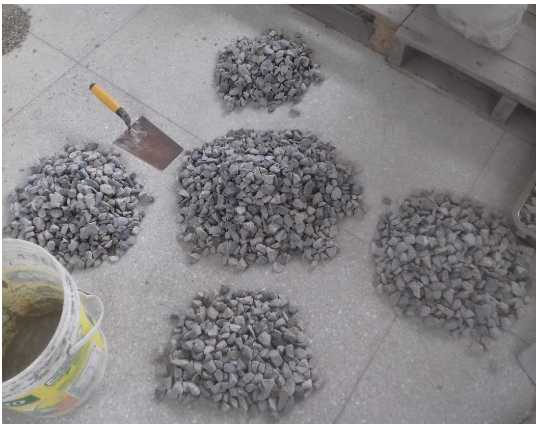
Fotografía 2 Método de cuarteo del agregado grueso
