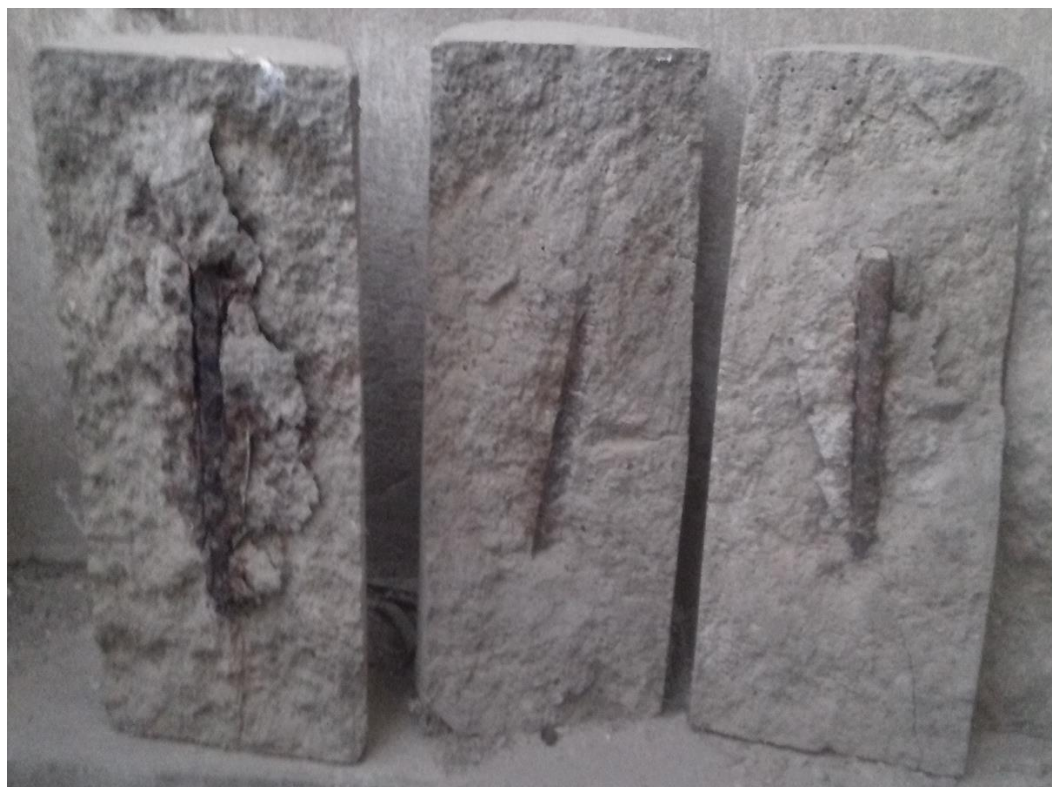
Fotografía 17 Muestras de mortero reforzado con acero de 3/8" de la investigación de Rimarachín
