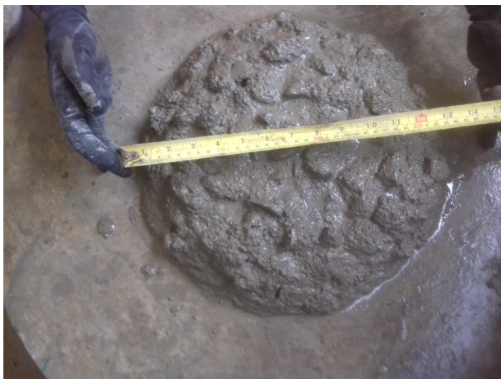
Fotografía 8 Muestra de concreto para ensayo de índice de consistencia
