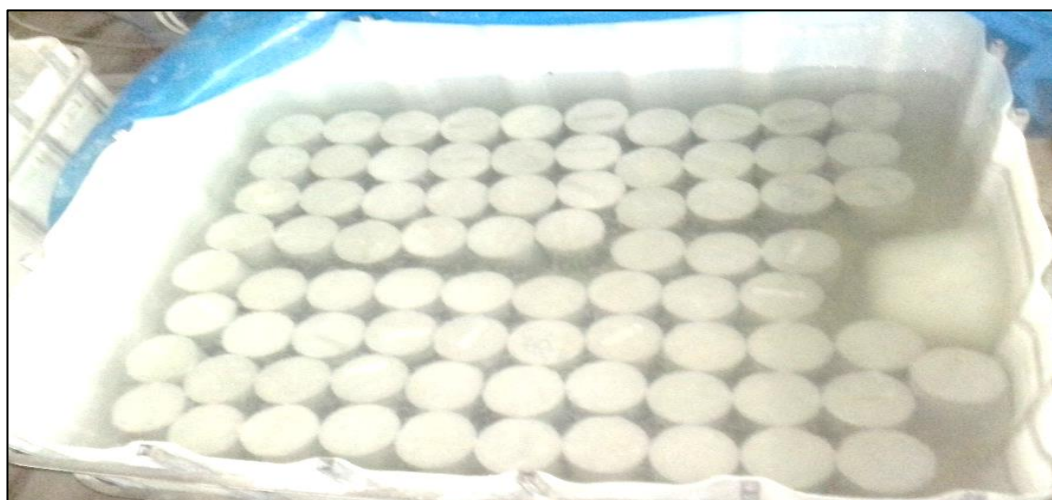
Figura N°14 Etapa de humedecido en probetas
