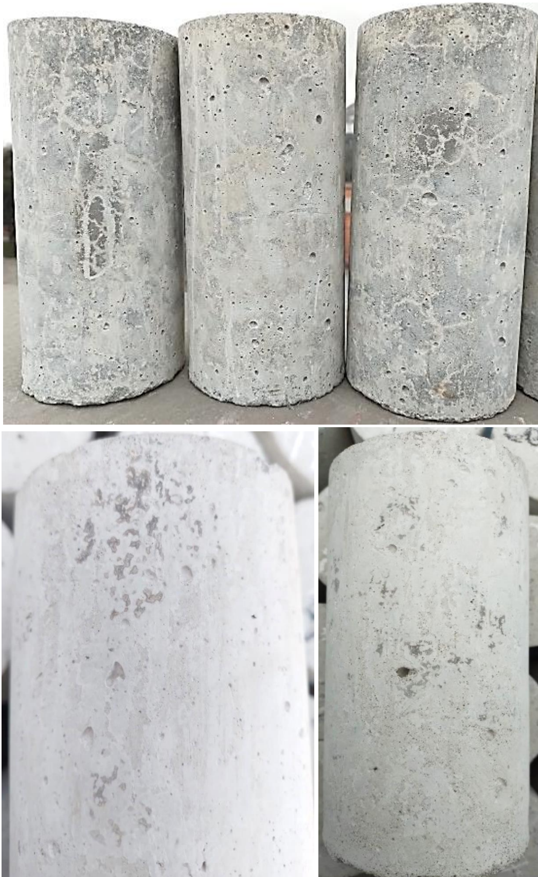
Figura N°29 Muestras con coloración rojo cobrizo claro en concreto armado
