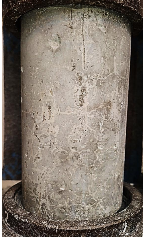
Fotografía 15 Muestras de concreto simple en el ciclo 30.
