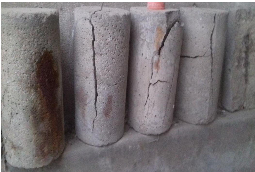
Fotografía 18 Muestras de mortero reforzado con acero de 3/8" de la investigación de Rimarachín
