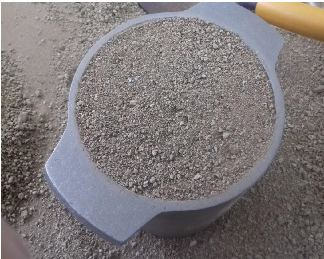
Fotografía 5 Muestra de agregado fino para ensayo de peso unitario
