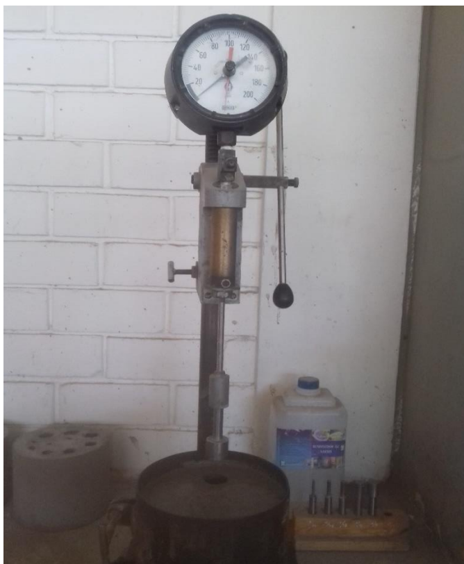
Fotografía 9 Muestra de concreto para ensayo de tiempo de fraguado
