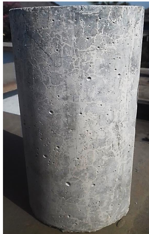
Fotografía 14 Muestras de concreto armado en el ciclo 20.
