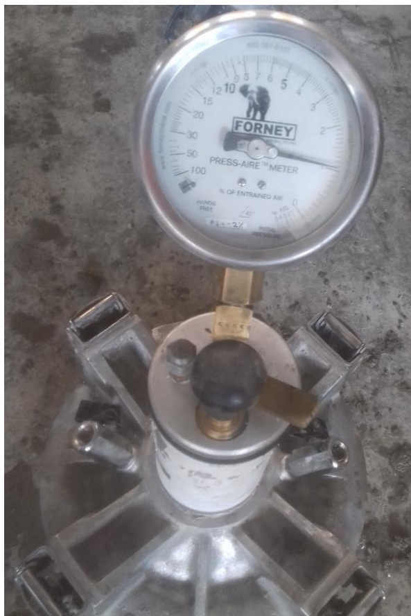
Fotografía 7 Muestra de concreto para ensayo de contenido de aire
