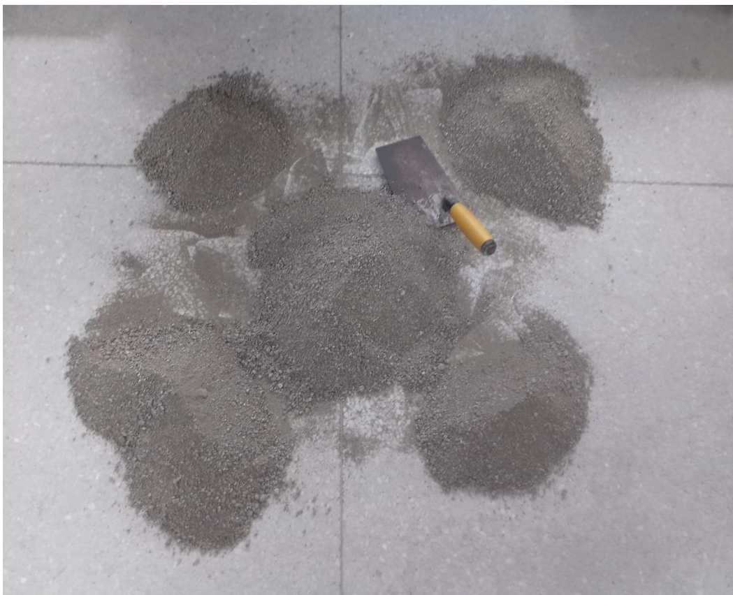
Fotografía 1 Método de cuarteo del agregado fino
