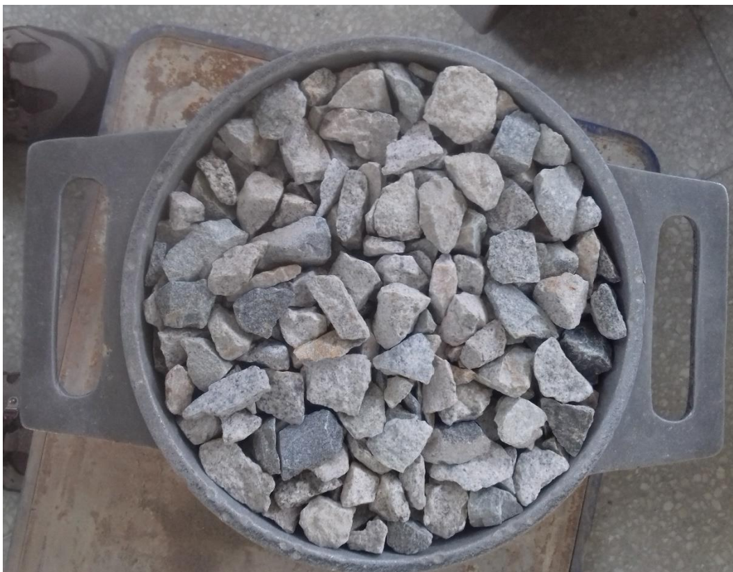
Fotografía 6 Muestra de agregado grueso para ensayo de peso unitario
