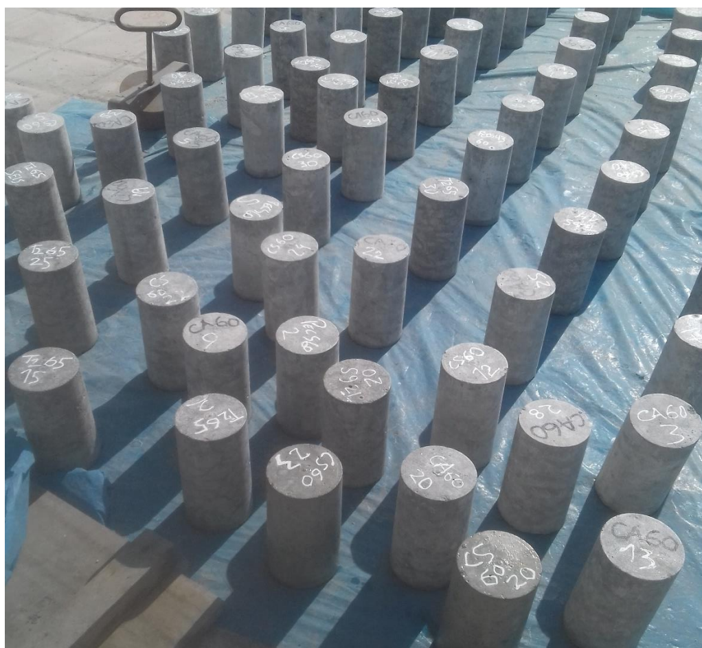
Fotografía 12 Muestras de concreto en el ciclo de secado
