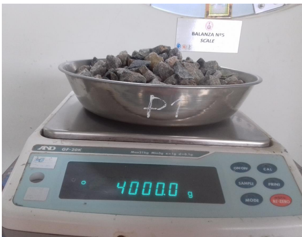
Fotografía 4 Muestra de agregado fino grueso ensayo de peso específico
