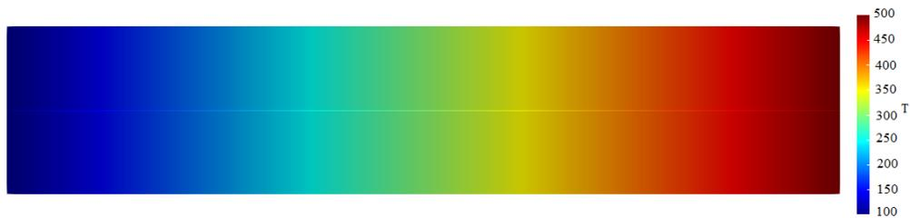
Figura 2.22: Resultado visual de la conductividad en una varilla.
