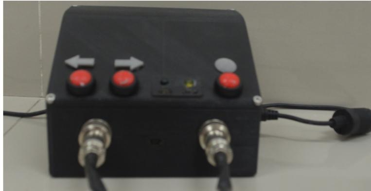
Figura 4.5: Controlador para las bombas.
