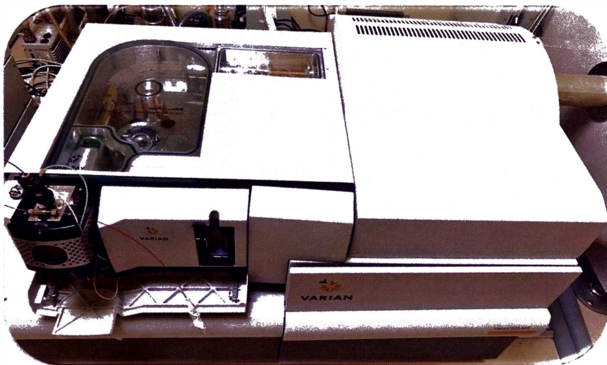
Figura 2. Espectrómetro de masas de triple cuadrupolo TQ Varian/Agilent MS-320. Foto tomada por Julio Barrios (2019).
