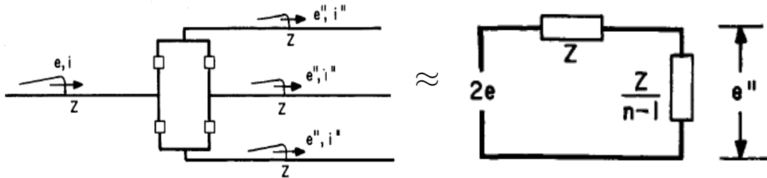
Figura 2.11. Una subestación con n líneas y su equivalente Thevenin Fuente: elaboración propia
