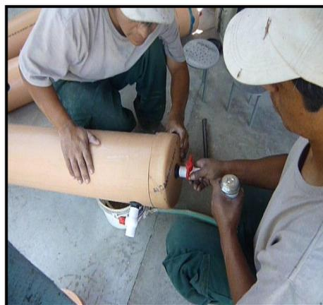
Fig. N°5: Válvula para limpieza y eliminación de Lodo.
