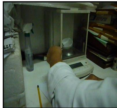
*Fig. N°47: Balanza para pesar los crisoles.*
