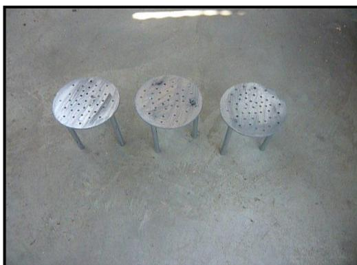
Fig. N°3: Vista de Planta de la rejilla de soporte para la granulometría.
