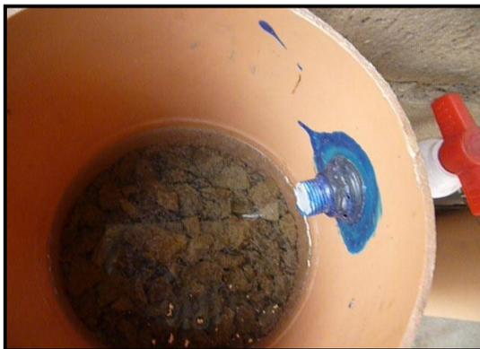
*Fig. N°13: Granulometría del Filtro*
