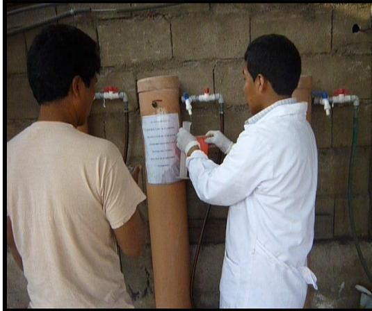
*Fig. N°23: Aforo del Caudal Diseño en el segundo Reactor. Se observa que se cierra la llave roja y se abre la azul.*
