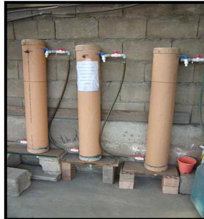
*Fig. N°20: Se uniformiza el flujo de agua cuando el desnivel es 10 cm por cada 50 cm de separación horizontal entre reactores.*
