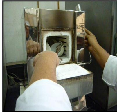
*Fig. N°45: Crisoles en la mufla.*
