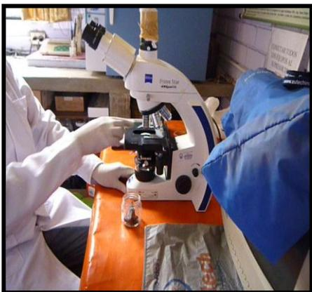
Fig. N°30: Microscopio (Primo Star Zeiss) para observar la formación de Capa Zogleal.
