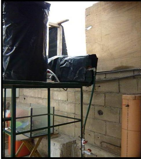
*Fig. N°54: Para evitar paso de la luz y el crecimiento de algas al interior del Reservorio y cámara de regulación, se procedió en cubrir con plástico de color negro.*
