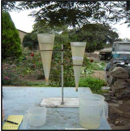
*Fig. N°25: Cono imhoff para los sólidos sedimentados.*
