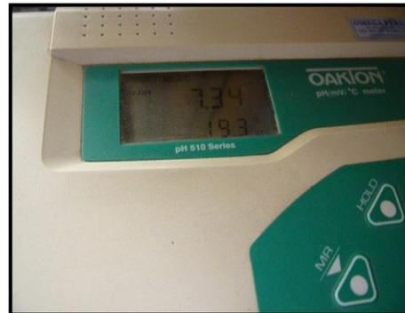
*Fig. N°49: Medición de PH y Temperatura.*
