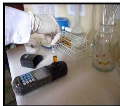
*Fig. N°35: Colorímetro para la medición de la DQO en el vial.*
