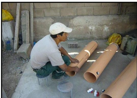
Fig. N°2: Tubos PVC 8" y 1.25 m.
