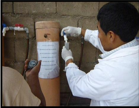
*Fig. N°19: Se afora el caudal diseño en la salida de cada reactor.*
