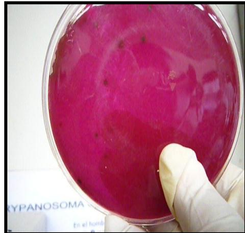
*Fig. N°55: Coliformes fecales a la salida del primer y segundo reactor.*
