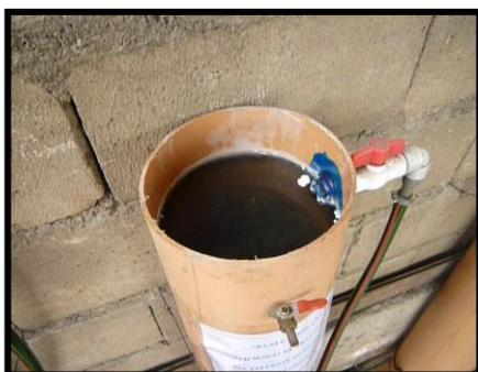
*Fig. N°27: Unidad de contacto, en la que las aguas residuales pasan a través de una masa de sólidos biológicos que se encuentra contenida dentro del reactor.*
