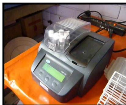
*Fig. N°34 : Digestor con viales de agua tratada en filtros anaerobios .*
