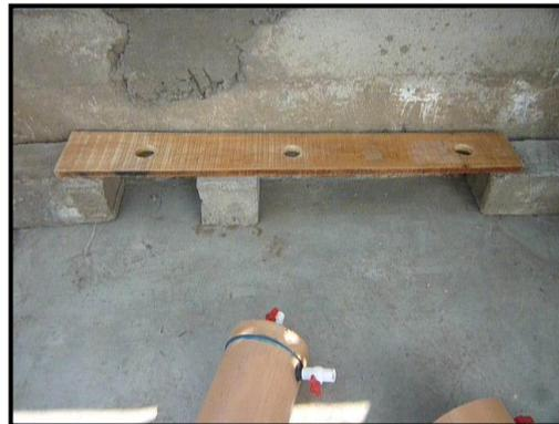
*Fig. N°53: Tabla de Base para la Batería de Filtros.*
