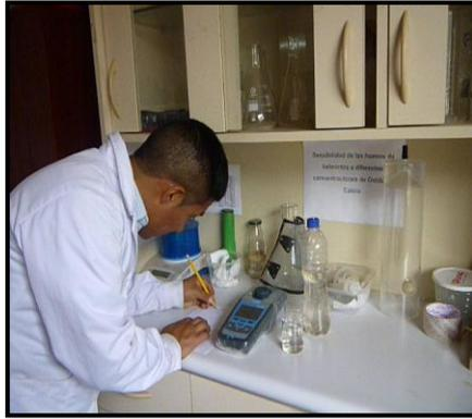
*Fig. N°48: Medición de turbiedad con Colorímetro (DR/850 marca HACH)*
