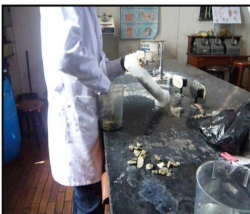
*Fig. N°14: Se coloca la granulometría en el Recipiente.*
