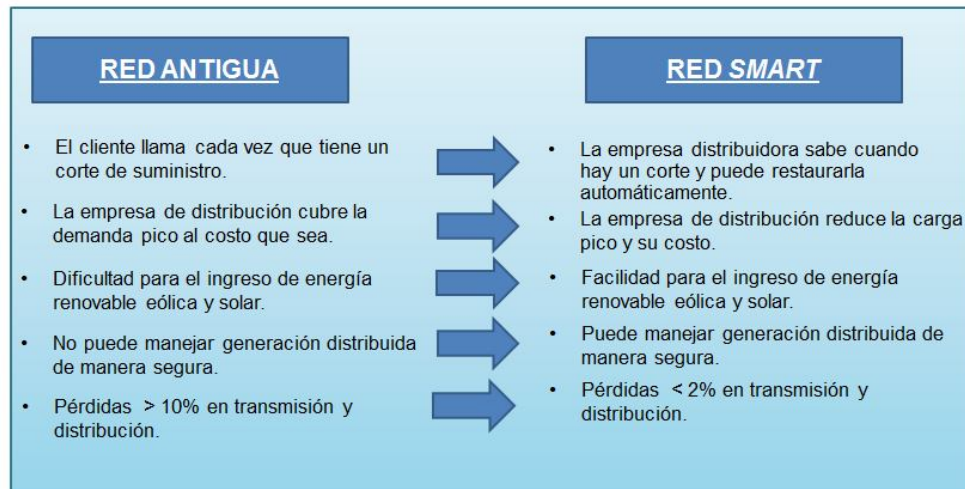
Figura 2.6: Malla Inteligente vs Sistema Tradicional. Fuente General Electric .
