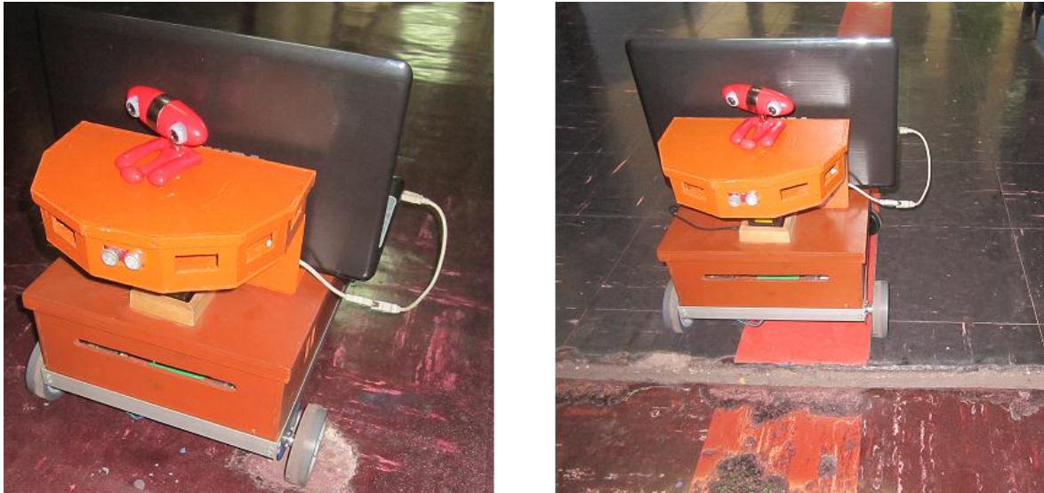
Figura 8.8. Imperfecciones en el piso del ambiente de navegación – Segunda prueba (Fuente: Elaboración propia)
