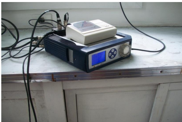
Fig. 7.5 analizador de gas de la combustión Marca Pierburg
