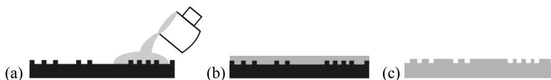
Figura 3. (a) Vaciado de PDMS sobre un molde. (b) Curado del PDMS. (c) Estructura de micro/nano-fluídica para LOC en PDMS.
