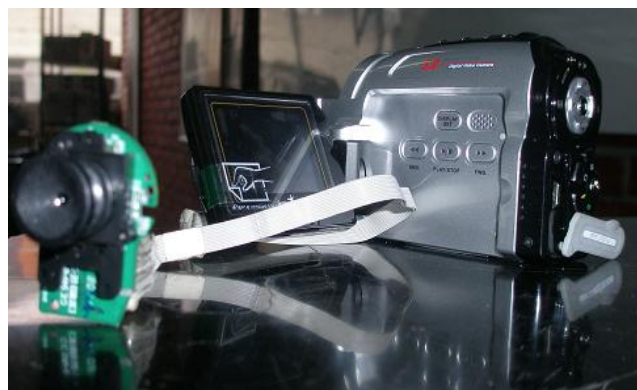
Figura 36. Cámara Genius DV 600 modificada para permitir el posicionamiento del sensor sobre el ocular.
