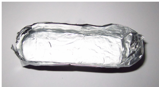
Figura 24. Contenedor donde se ha colocado el molde fabricado con el método desarrollado.
