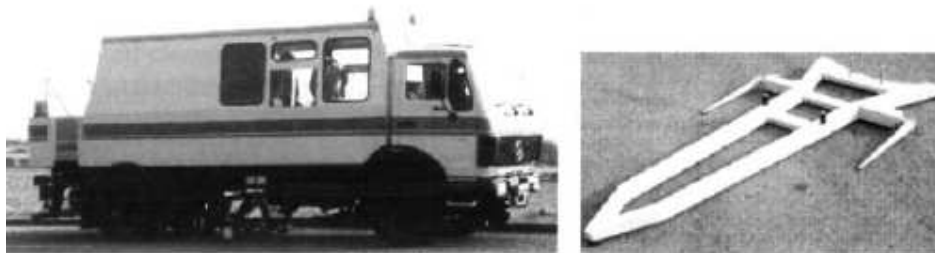
Deflectómetro Lacroix y sus respectivas vigas de medición (Solminihac, 1998)
