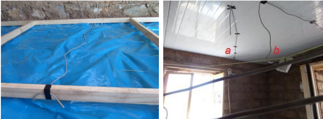
Figura 4.2.2. A la izquierda, fotografía de la posición del sensor de temperatura en el espacio que cubrirán las planchas de poliuretano formando el piso. A la derecha, fotografía de los sensores que miden la temperatura del ambiente interior de la habitación sur, el sensor “a”, que viene del fondo, pertenece al control automático de encendido y apagado de la bomba hidráulica, mientras que el sensor “b” es el que pertenece a la serie de sensores del plan experimental.
