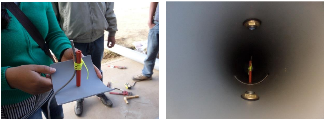
Figura 4.2.3. A la izquierda, fotografía del dispositivo hecho para sostener el sensor que medirá la temperatura del agua en el interior del tubo radiante ubicándolo a 0,30m de cada uno de sus dos extremos. A la derecha, la fotografía deja ver el dispositivo con el sensor en su posición final en el interior del tubo radiante.
