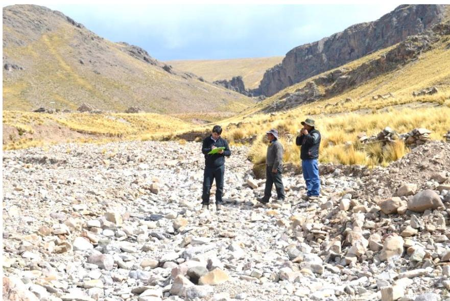
**Figura 3.15** Trabajo de campo en la quebrada Callampure, (código SW-080). En la base del río, se tiene depósitos cuaternarios (gravas, cantos y bloques). En la margen izquierda, existen zonas de alteración hidrotermal y en la margen derecha afloran lavas andesíticas del centro volcánico Cosana.
