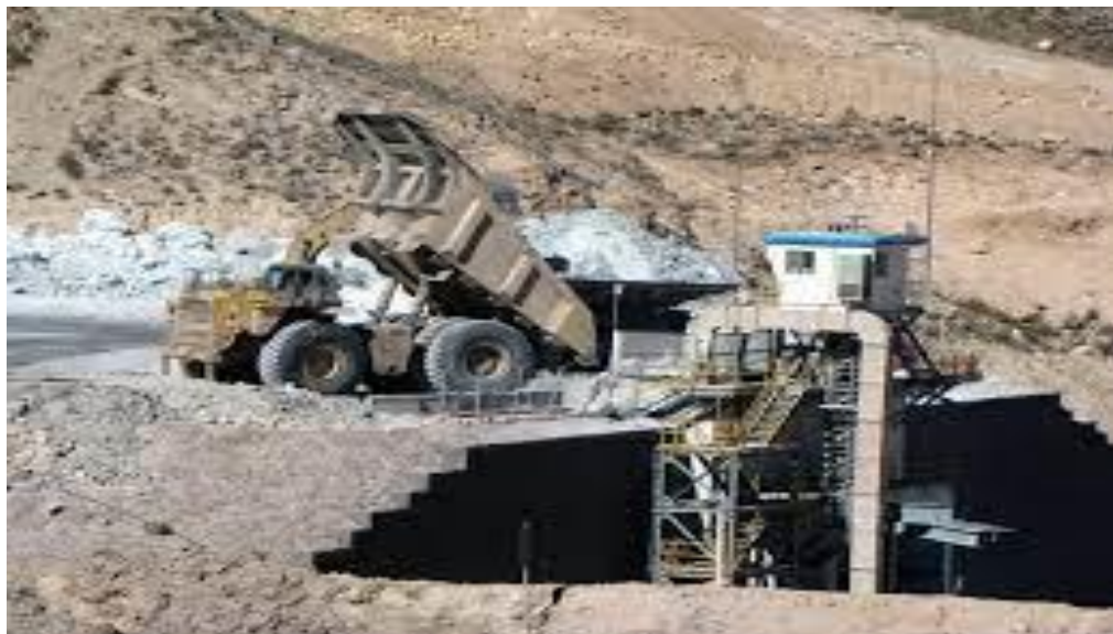
Figura 2, 18 Relación del chancado con el carguío y transporte
