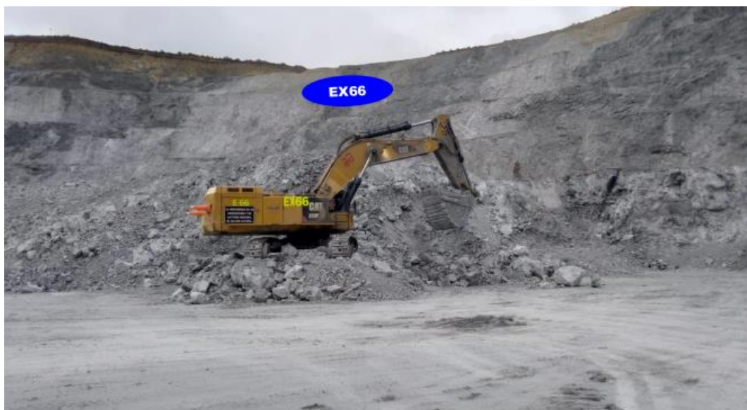
Figura 2, 14 Frente de carguío con mala fragmentación
