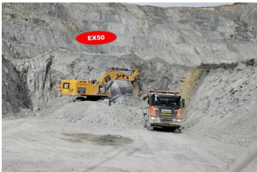
Figura 2, 1 Excavadora CAT390 FL y volquete en un frente angosto de la unidad minera
