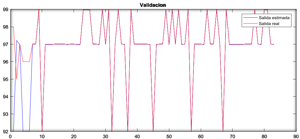
Figura 4.18 Validación de la Red Neuronal, con 5 neuronas en cada capa oculta y con un error de 1.65%
