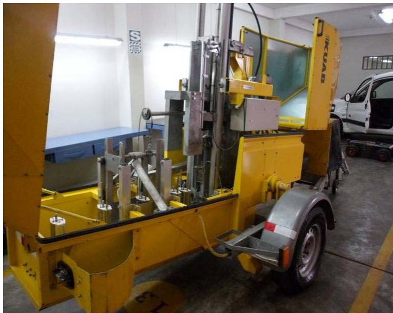
Fotografía 5.1 Vista interior del Deflectómetro de Impacto Marca KUAB Fuente: Elaboración Propia
