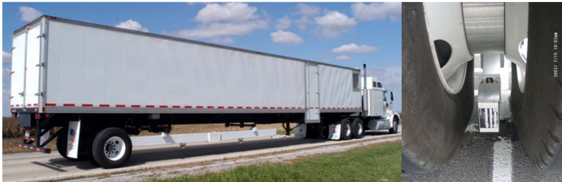
Fotografía 3.1 Rolling Wheel Deflectometer – ARA / Fotografía 3.2 Laser entre las ruedas duales Fuente: http://www.fhwa.dot.gov/pavement/management/rwd/
