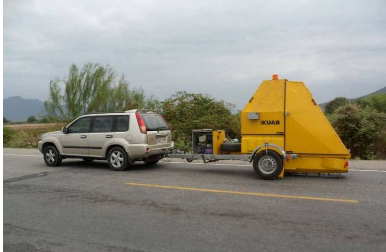
Fotografía 5.2 Vista Panorámica del Deflectómetro de Impacto Marca KUAB Fuente: Elaboración Propia
