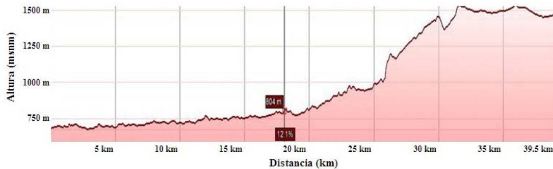
Figura 4.2 Perfil de Elevación de la Carretera Puente Raither – Puente Paucartambo – Villa Rica Fuente: Google Earth
