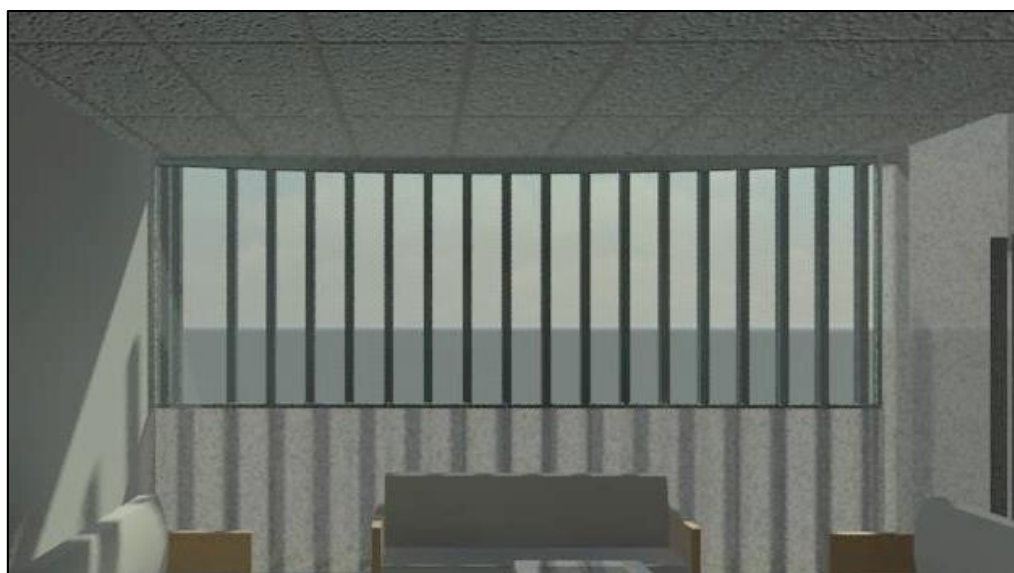
Figura 87: Materiales acústicos en el techo y en las ventanas que permitan el control del ruido del exterior.
