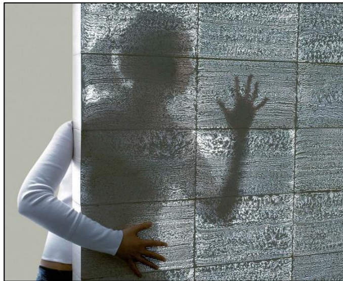
Figura 46: Concreto Translucido de fibra óptica
