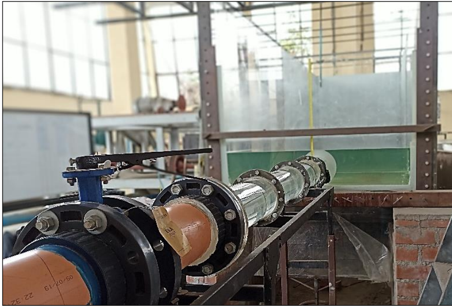
Foto 4: Toma sumergida a la salida de la cámara de carga.
