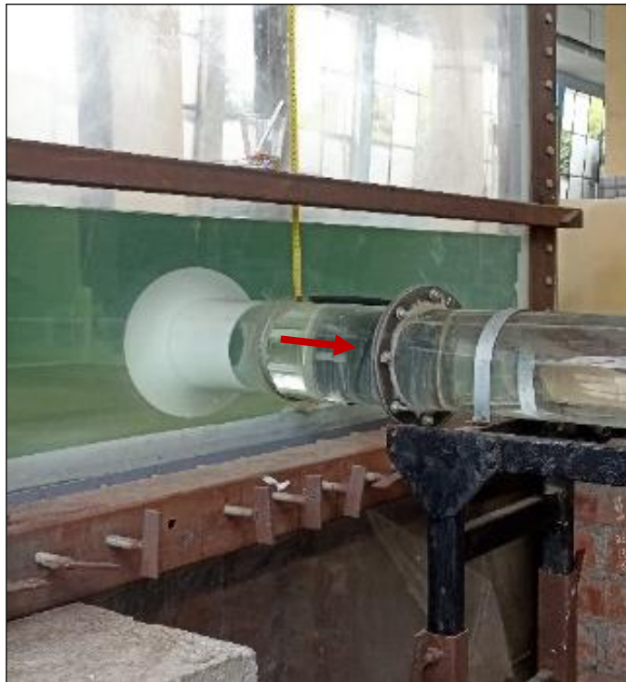
Foto 1: Vista de la toma sumergida, donde se indica el sentido del flujo.
