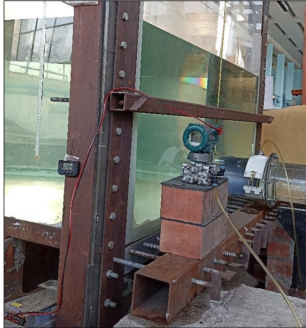
Foto 9: Toma de datos con transmisor de presión.
