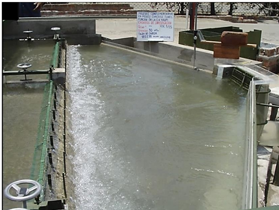
Foto 11: Cámara de carga del modelo físico utilizado por Zubiaur (2011).
