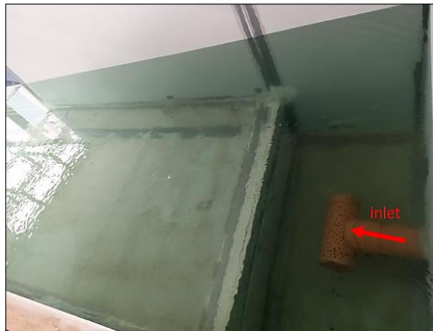
Foto 2: Entrada de flujo hacia la cámara de transición y disipación de energía.
