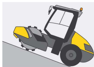
Figura N° 4 Rodillo pata de cabra
