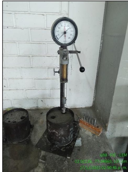
Figura 142. Ensayo de Resistencia a la Penetración en el Tiempo. (Capítulo 5.1.3; pág. 51)
