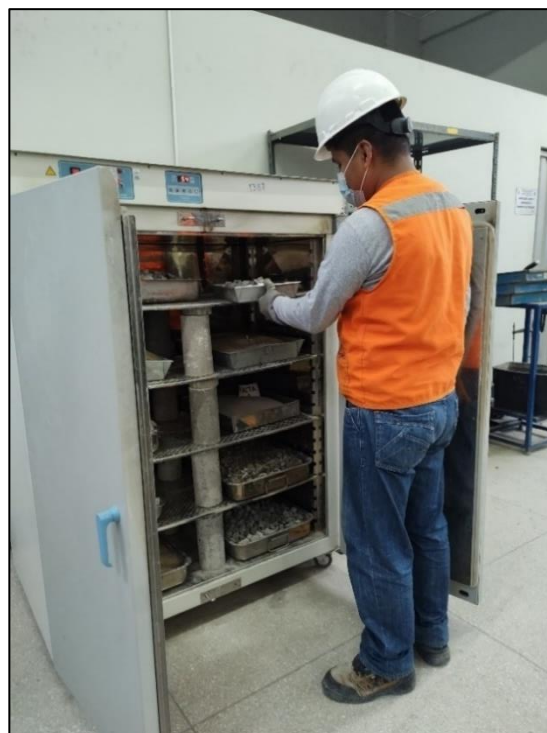
Figura 120. Secado al Horno del Agregado Grueso y Fino. (Capítulo 3.4; pág. 35)
