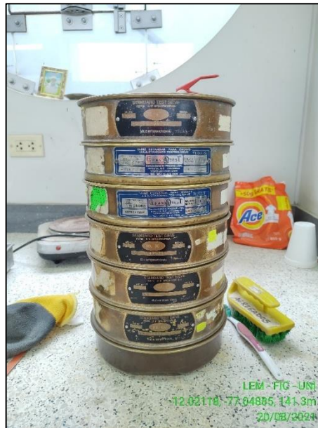
Figura 106. Tamiz de Ensayo para Agregados Finos. (Capítulo 3.1; pág. 31).
