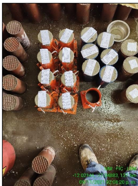
Figura 143. Llenado y Compactado del Concreto en Probetas de 4" x 8". (Capítulo 5.2.1; pág. 95)
