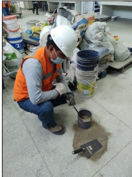
Figura 117. Compactado del Agregado Fino. (Capítulo 3.3; pág. 34)
