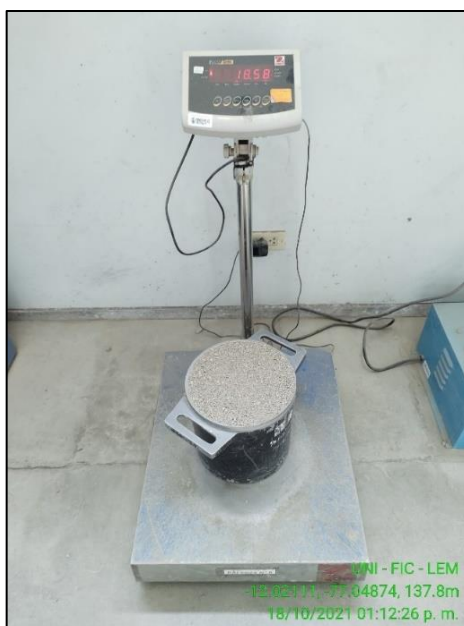
Figura 115. Pesaje del Material de Agregado Fino en Estado Suelto. (Capítulo 3.2; pág. 33)
