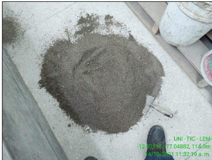
Figura 112. Muestra Representativa del Agregado Fino. (Capítulo 3.2; pág. 33)
