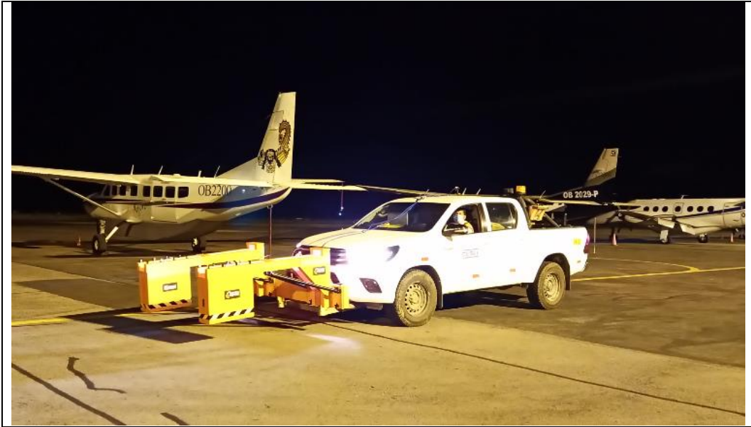
Foto N° 05: Medición con equipo Georadar (GPR).
