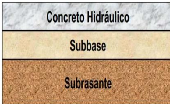
Figura N°2 Sección Transversal típica de un pavimento rígido
