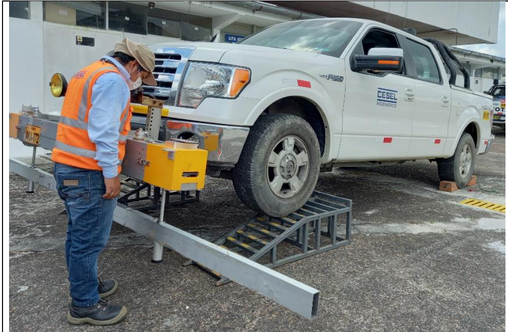
Foto N° 03: Calibración del perfilómetro láser (RSP).
