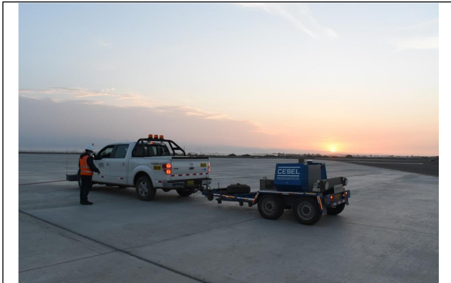
Foto N° 01: Medición con el Deflectómetro de Impacto (HWD) transferencia de carga.
