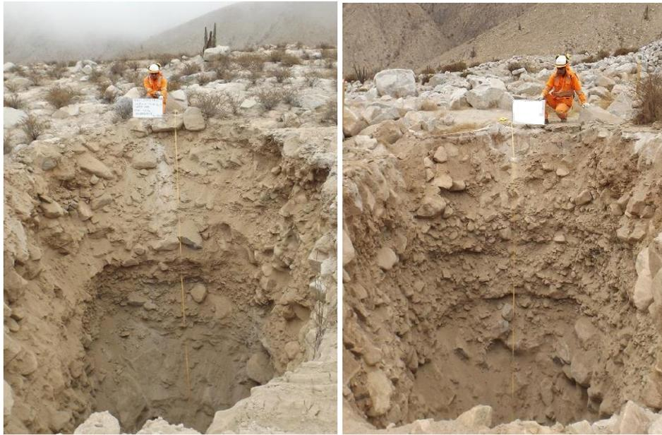
Figura N°3.20: Calicata en suelo aluvial
