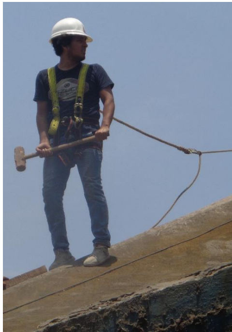
Figura Nº E.5 Excitación forzada de la estructura para la medición de vibración ante fuerzas externas.
