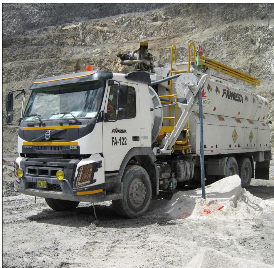
Figura 06. Carguío de taladros con camión fábrica
