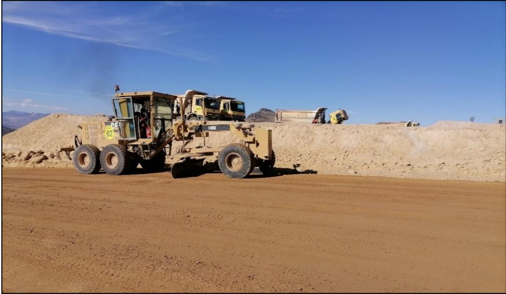
Figura 24: Motoniveladora 140K realizando mantenimiento de vías en la vía minera antes de la aplicación del aditivo.
