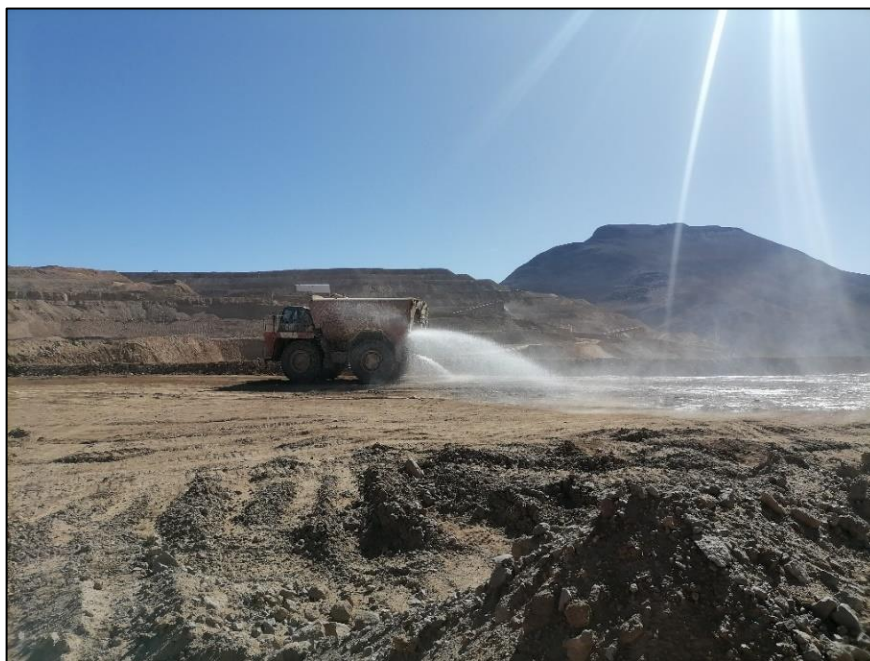
Figura 16. Método de riego convencional en minería.
