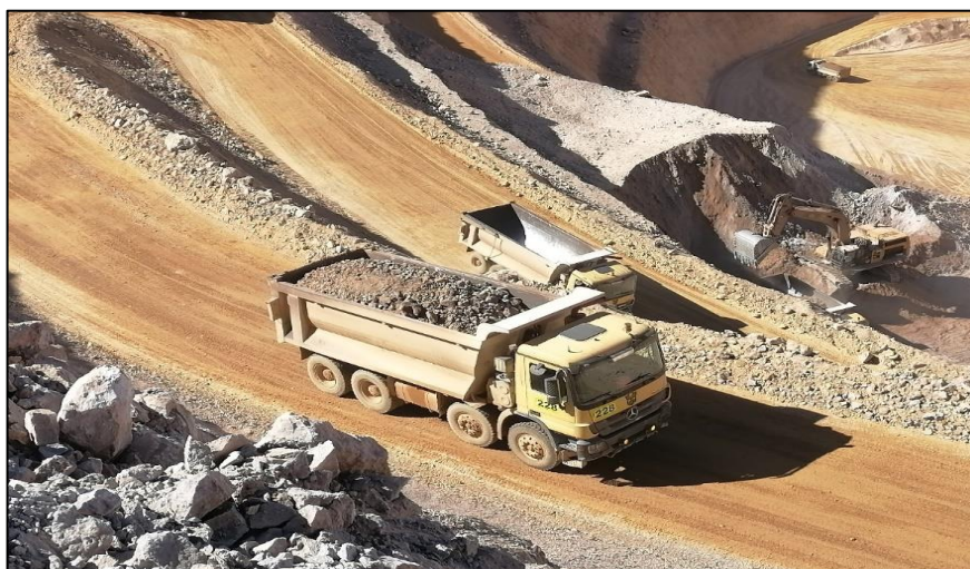
Figura 09. Volquete de 22m 3 acarreando mineral de Tajo hacia Pad Lixiviación.
