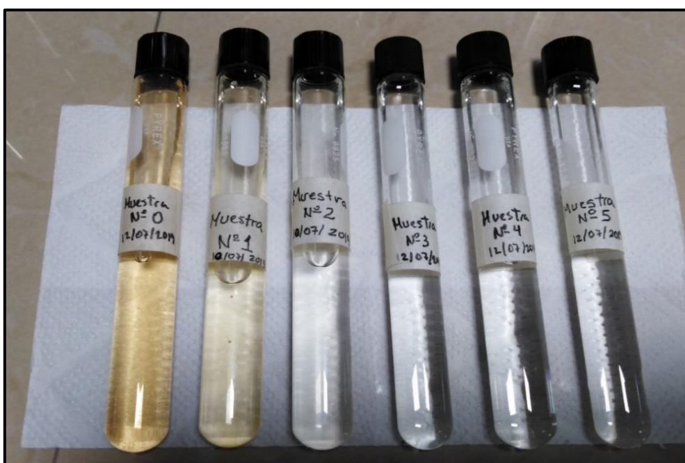
Figura 3.30. Muestras resultantes de las titulaciones a \text{pH}=3 , \text{pH}=4 , \text{pH}=5 y \text{pH}=6 de la Muestra A
