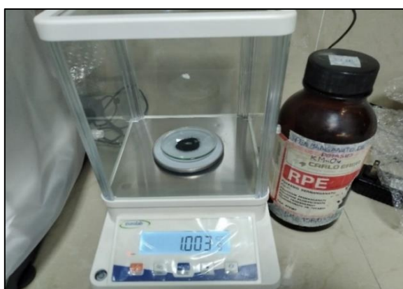
Figura 3.1. Pesaje del insumo precursor ( \text{KMnO}_4 )
