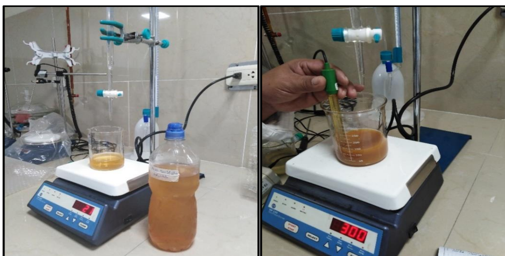
Figura 3.23. Titulación de la Muestra A para llevar a \text{pH}=7
