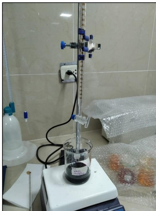
Figura 3.3. Titulación con alcohol etílico en 96%
