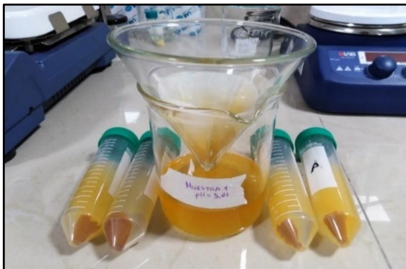
Figura 3.26. Filtración de solución centrifugada a pH=3
