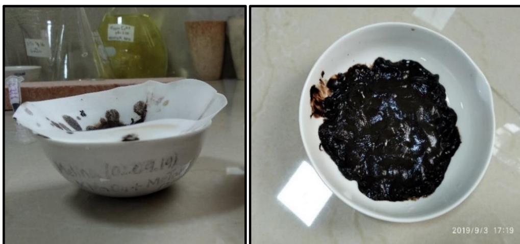
Figura 3.19. Preparación de la muestra para su posterior secado en estufa
