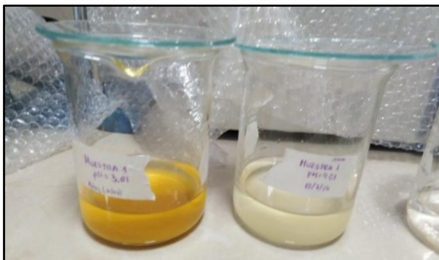
Figura 3.27. Filtración de solución centrifugada a pH=4
