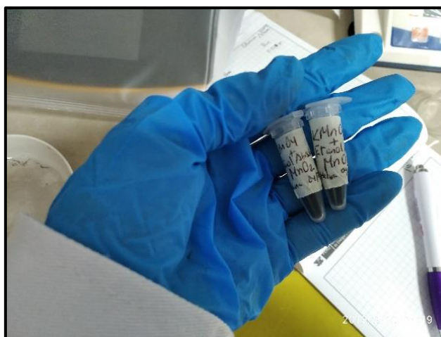
Figura 3.15. Muestras de \text{MnO}_2\text{-}\alpha obtenidos a partir de titulación con etanol absoluto
