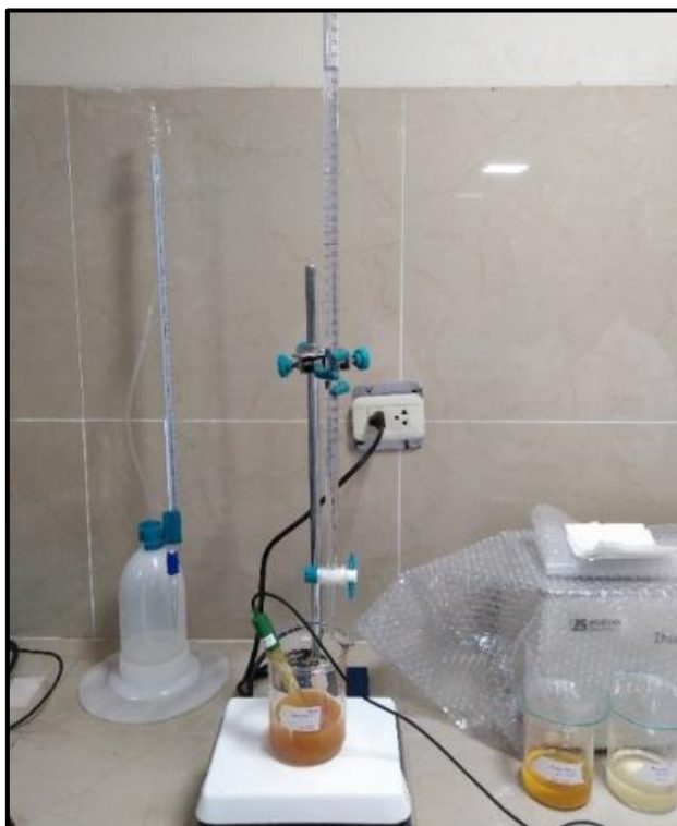
Figura 3.28. Titulación de la muestra a pH=5
