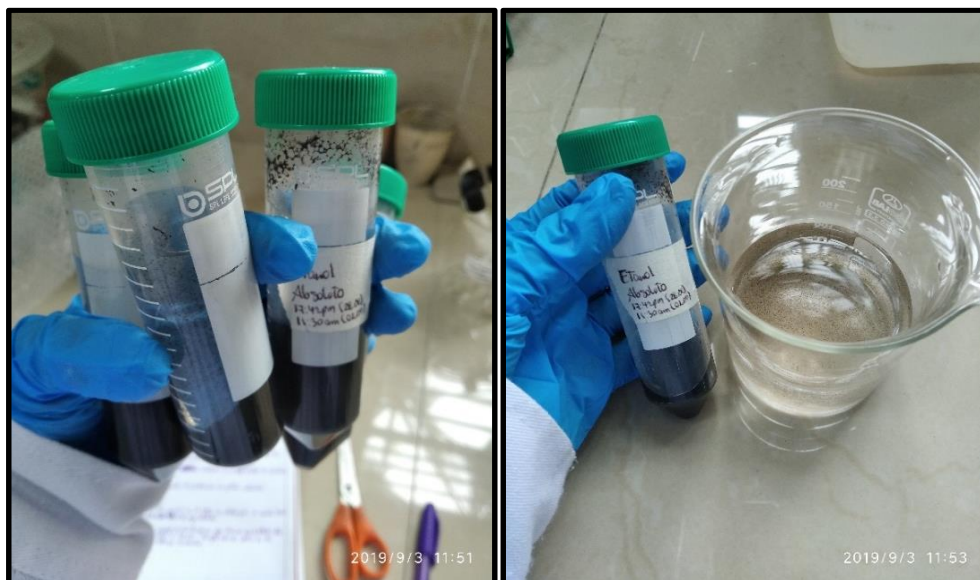
Figura 3.11. Lavado de la muestra con centrifugado
