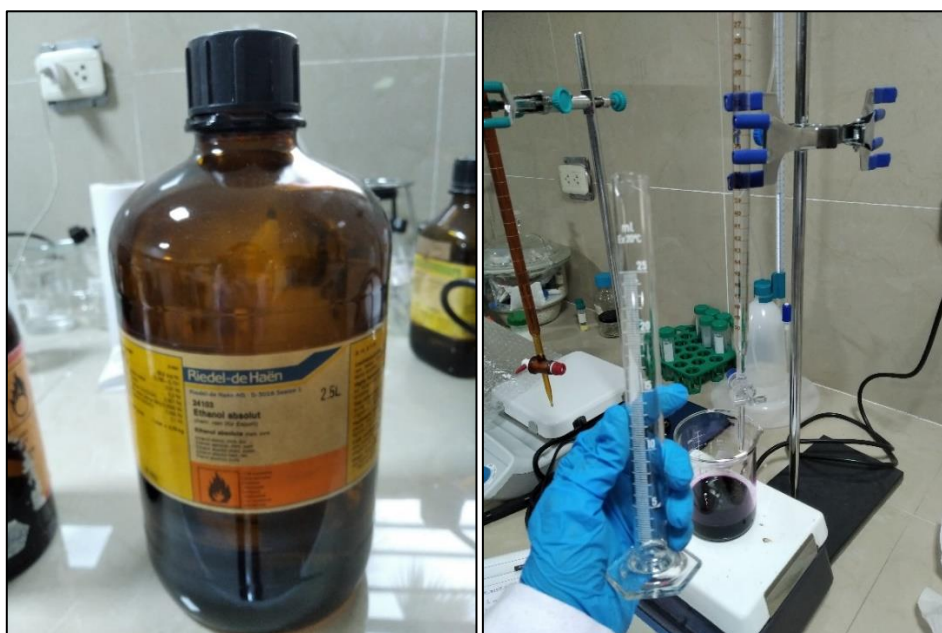
Figura 3.8. Titulación del KMnO_4 con etanol absoluto
