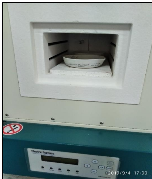
Figura 3.14. Calcinación de la muestra a 500°C por 2hr en horno Mufla
