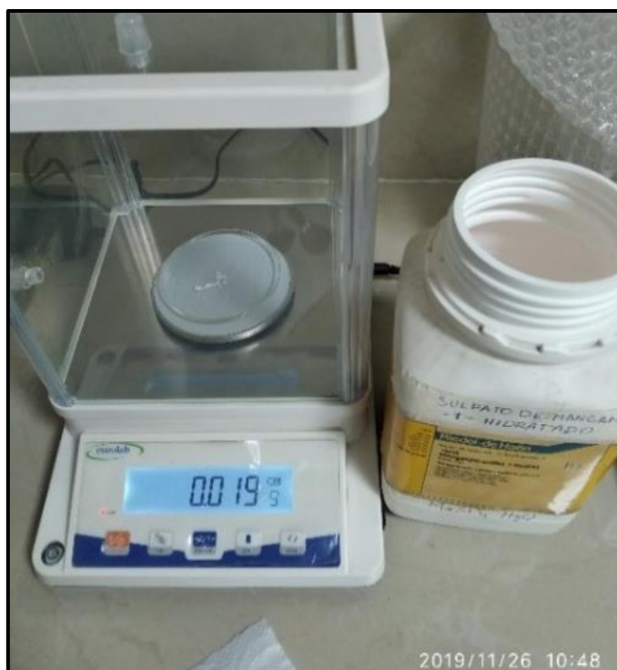
Figura 3.21. Pesaje del reactivo con contenido de manganeso
