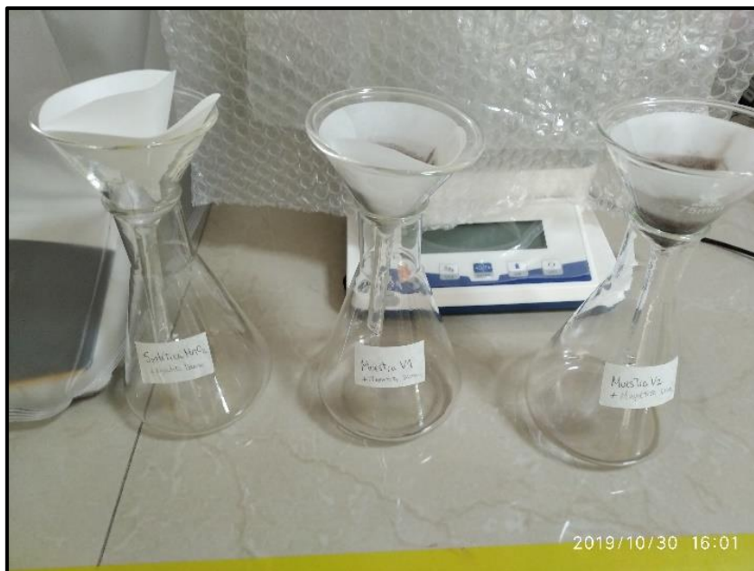
Figura 3.34. Filtrado de las muestras tras finalizar el tiempo de agitación
