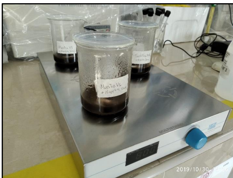
Figura 3.33. Remoción de Mn empleando nanopartículas a diferentes tiempos de remoción en Plancha de Agitación
