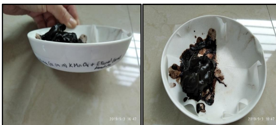
Figura 3.12. Muestra colocada en crisol de porcelana para someterla a secado en estufa
