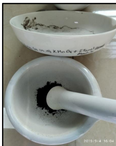
Figura 3.13. Desaglomeración empleando mortero de la muestra secada en estufa
