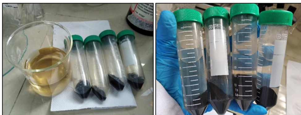
Figura 3.6. Lavado de las muestras empleando tubos de centrifuga
