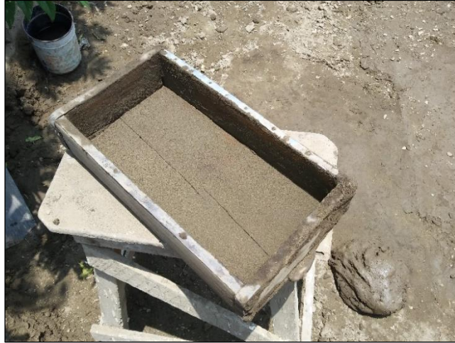
Figura N° 8: Molde para la elaboración del adobe Fuente: Elaboración propia
