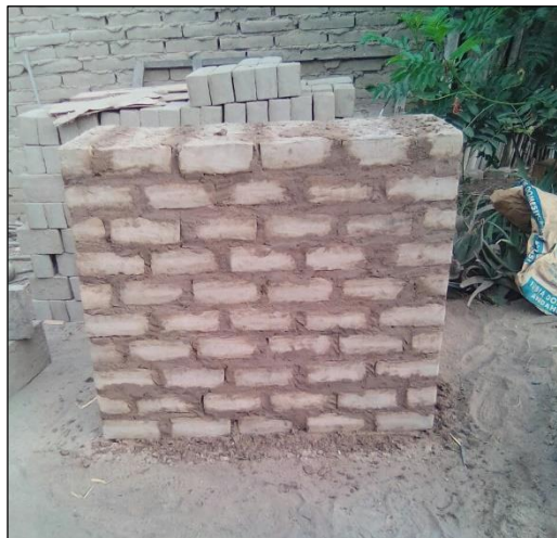
Figura N° 13: Muro de adobe de 1.00 x 1.00 m Fuente: Elaboración propia
