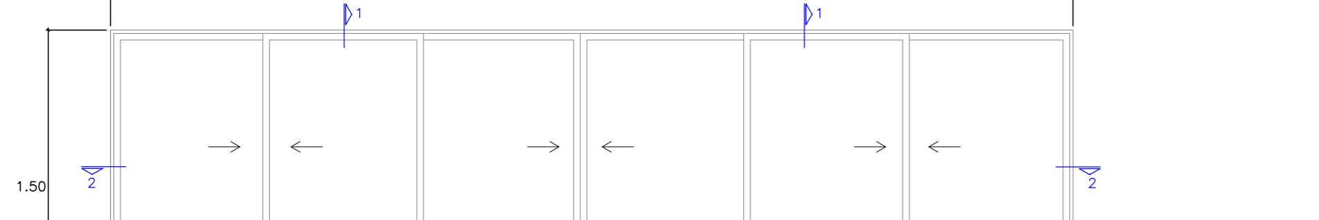
V-7 (0.85X2.10) Esc. 1:25 Ventana de Aluminio Anodizado Cristal Templado Incoloro en-ferm. Tipo galbana (9 unidades)
