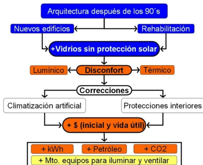
Fig. 10. Esquema que sintetiza la problemática del uso de la carpintería de vidrio sin control solar en la arquitectura.
