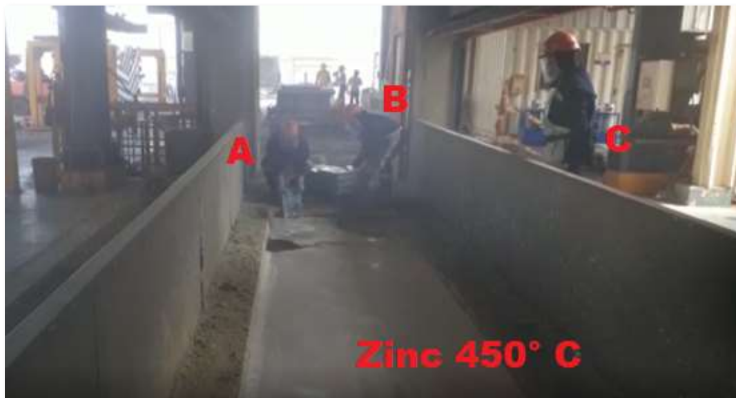
Fig. 5.3 – Tarea operacional. Inmersión de lingotes de zinc en lecho de zinc a 450°C.
