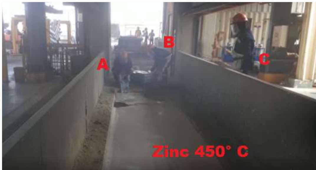
Fig. 1.8 – Inmersión de lingotes de zinc en lecho de zinc fundido a 450°C.
