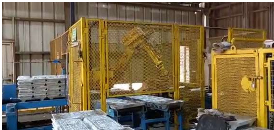
Fig. 1.2 - Etapa de apilamiento de Lingotes de Zinc.
