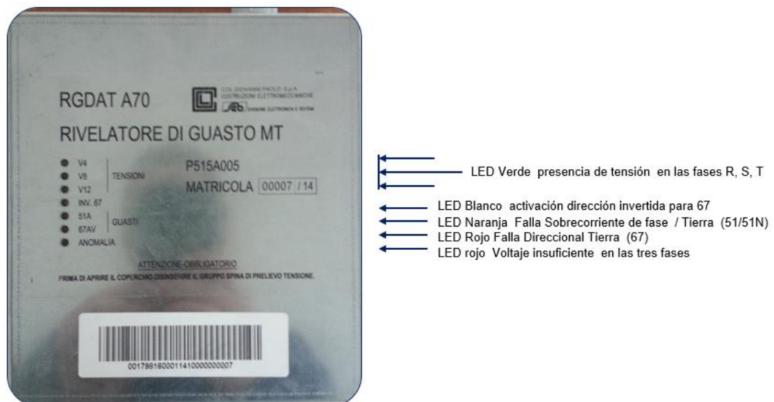
Ilustración 2-18: Señalización Led de RGDAT Interior.
