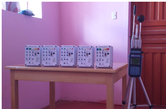
Figura 18. Fotografía de los dispositivos Delta Ohm HD 32.3 y TSVR al interior de una vivienda de Imata.
