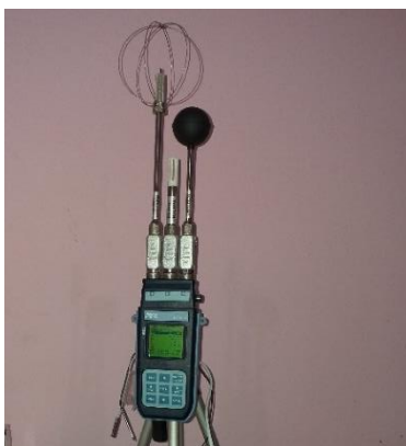
Figura 21. Instrumento Delta Ohm HD 32.3 para la medición de parámetros como la temperatura, la humedad relativa y la velocidad de viento en Imata.
