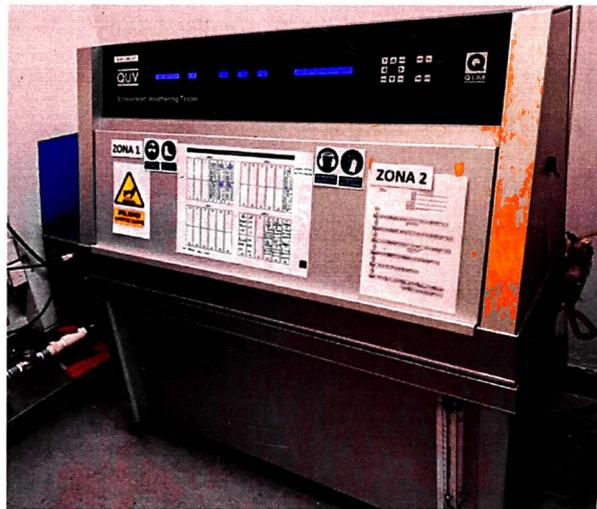
Figura 32. Equipo cámara de envejecimiento QUV
