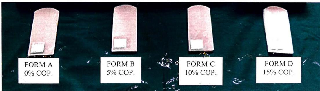
Figura 33. Muestras para evaluar en equipo QUV/Basic
