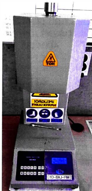
Figura 15. Plastómetro de extrusión
