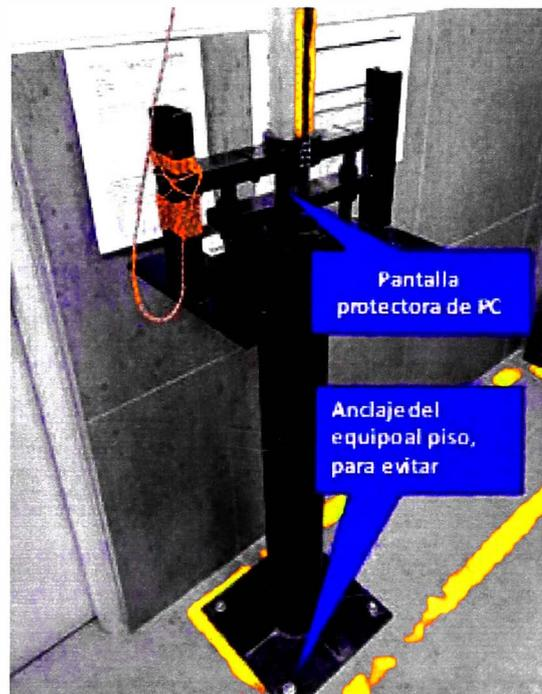
**Figura 30.** Equipo Gardner para ensayo de impacto
