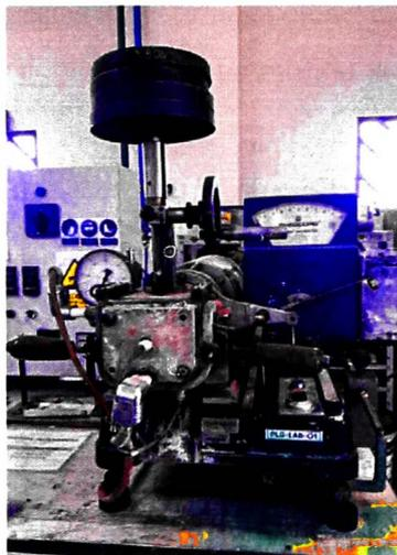
**Figura 16.** *Equipo Brabender o reómetro de torque*
