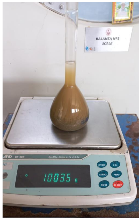
FIGURA A.22 Peso de la arena superficialmente seca + peso del balón + peso del agua
