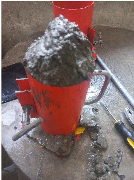
FIGURA A.39 Probetas de concreto antes de ser desmoldadas
