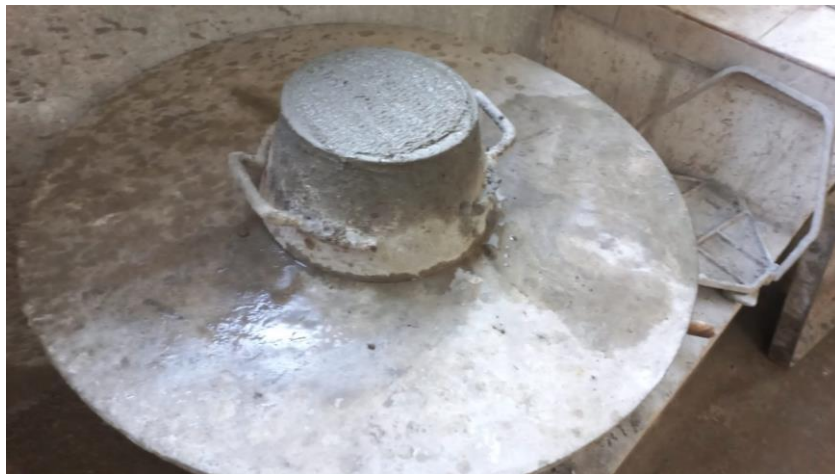
FIGURA A.29 Ensayo de fluidez del concreto patrón
