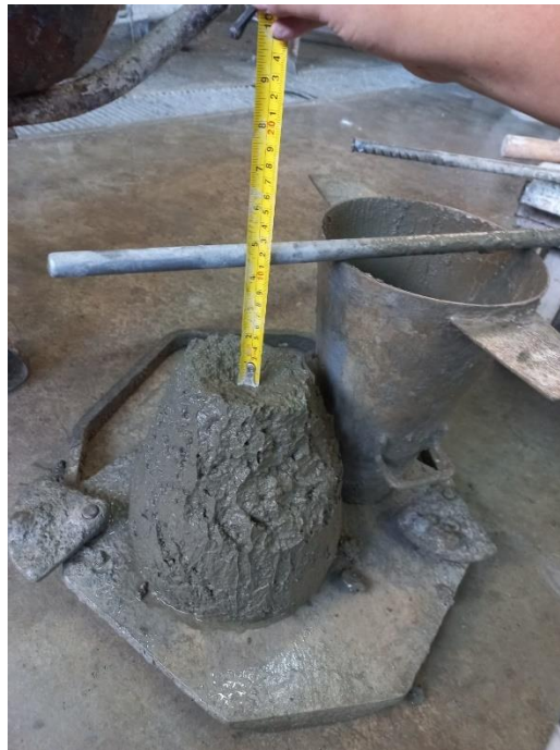
FIGURA A.26 Asentamiento del concreto patrón
