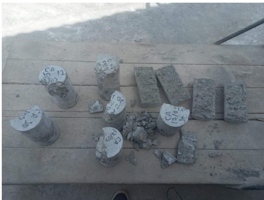
FIGURA N° 36 Estado de las probetas luego de ser ensayadas
