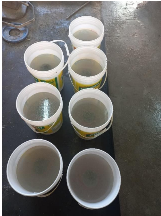
FIGURA A.38 Probetas de concreto con aditivo vaciadas bajo agua
