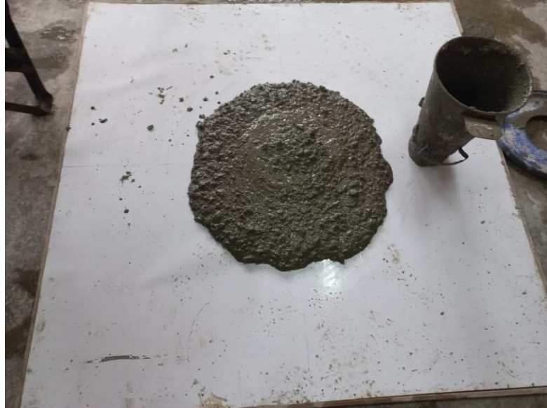
FIGURA A.32 Fluidez de asentamiento del concreto con aditivo
