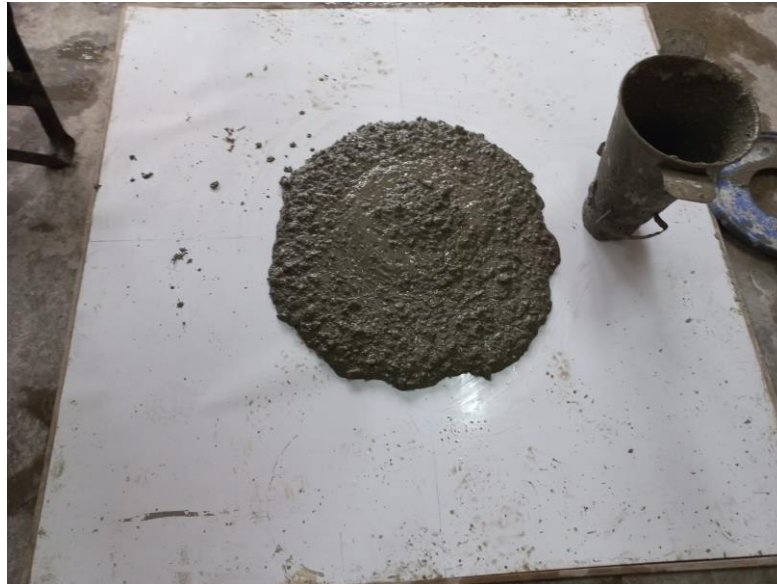
FIGURA N° 19 Fluidez de asentamiento del concreto con aditivo
