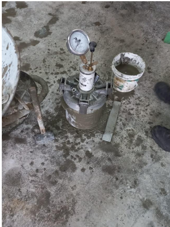
FIGURA A.34 Ensayo de contenido de aire
