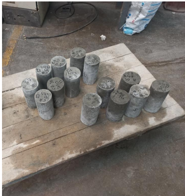
FIGURA A.41 Probetas de concreto luego de ser cortadas
