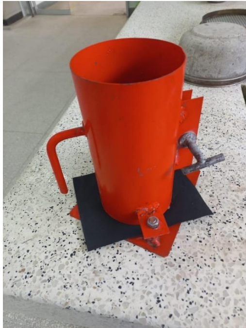
FIGURA A.36 Molde metálico de 4x8" con base de corrospum
