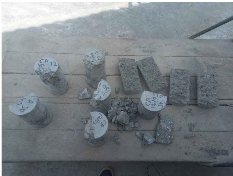
FIGURA A.43 Rotura de probetas de concreto con aditivo
