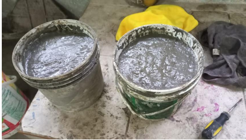
FIGURA A.28 Ensayo de exudación del concreto
