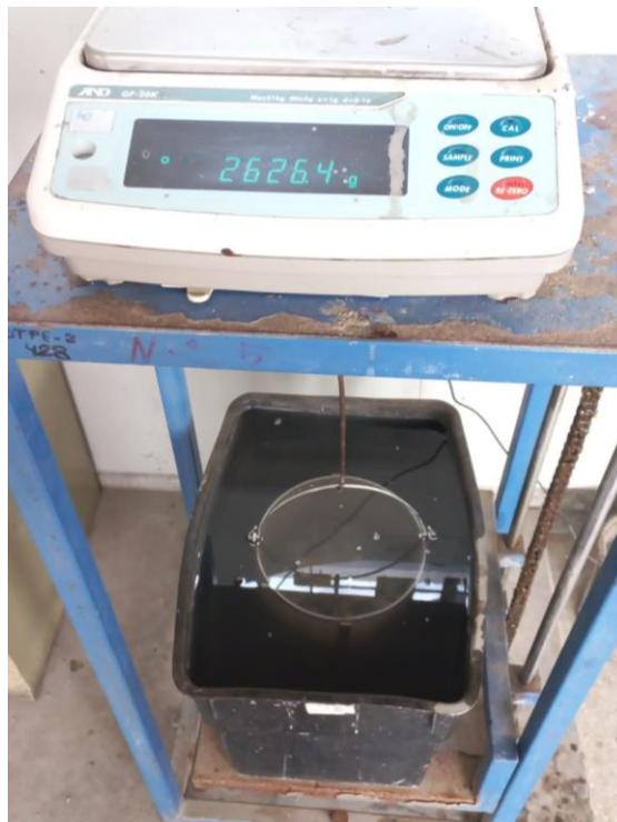
FIGURA A.24 Peso de la piedra saturada en agua
