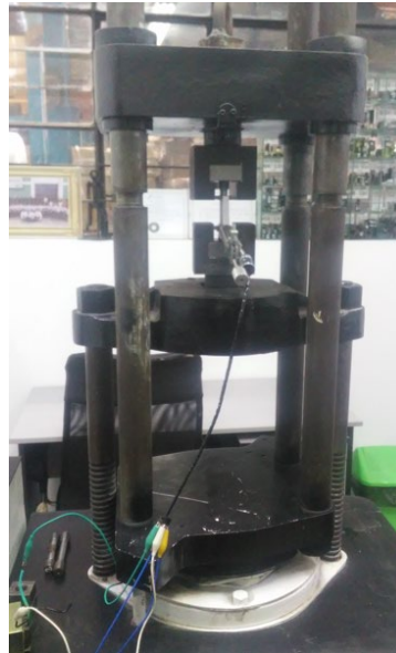
Figura 35: Acople del extensómetro LVDT junto con la probeta en la máquina universal
