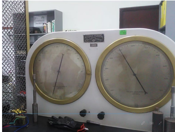
Figura 28: Lectores análogo libra-fuerza de la máquina de tracción
