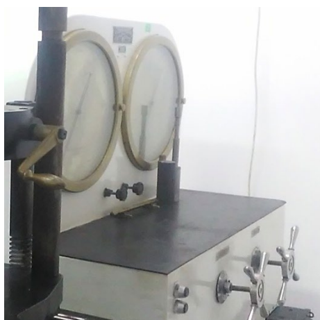
Figura 8: Unidad de potencia en máquina de tracción
