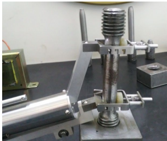
Figura 44: Probeta mecánica acoplada al extensómetro LVDT
