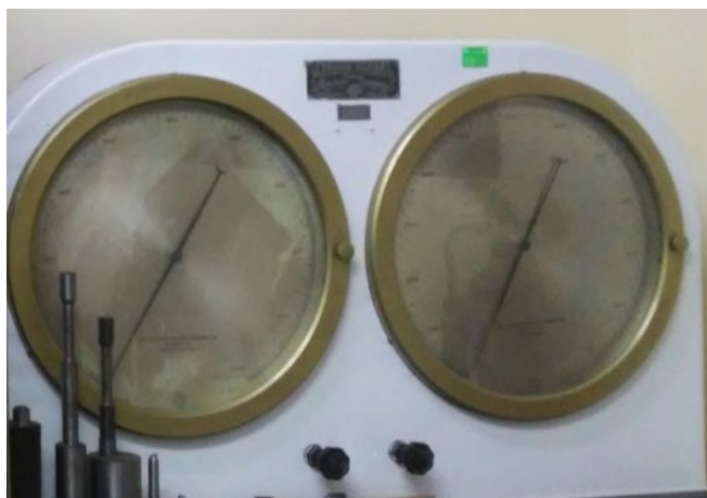
Figura 9: Lectores análogos en una máquina de tracción
