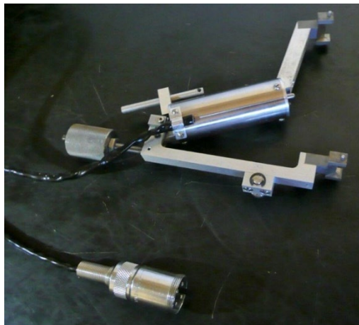
Figura 15: Extensómetro LVDT con pines de conexión
