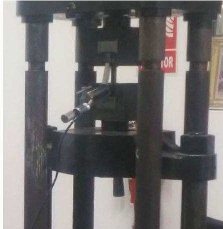
Figura 45: Probeta y extensómetro acoplado en la máquina universal
