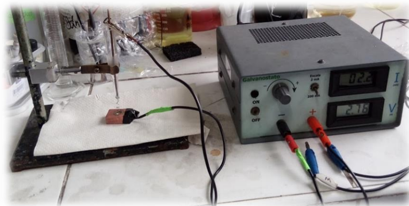
Figura 31: Esquema de electrodeposición de oro.
