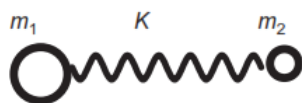
Figura 8: Representación de la oscilación de dos esferas unidas por un muelle elástico 35 .
