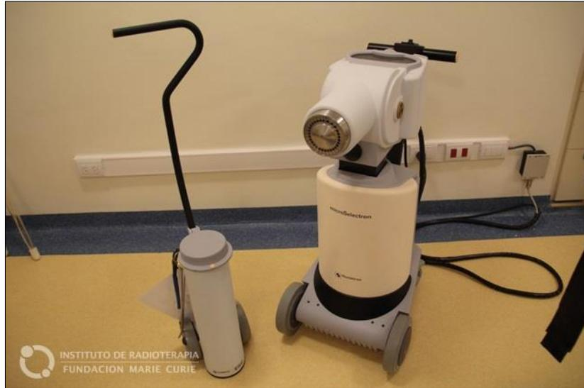
FIG. A.1. Unidad de braquiterapia microSelectron® Digital HDR-v3 (web institucional del Instituto Privado de Radioterapia de Córdoba (IPR), Córdoba-Argentina [65]).
