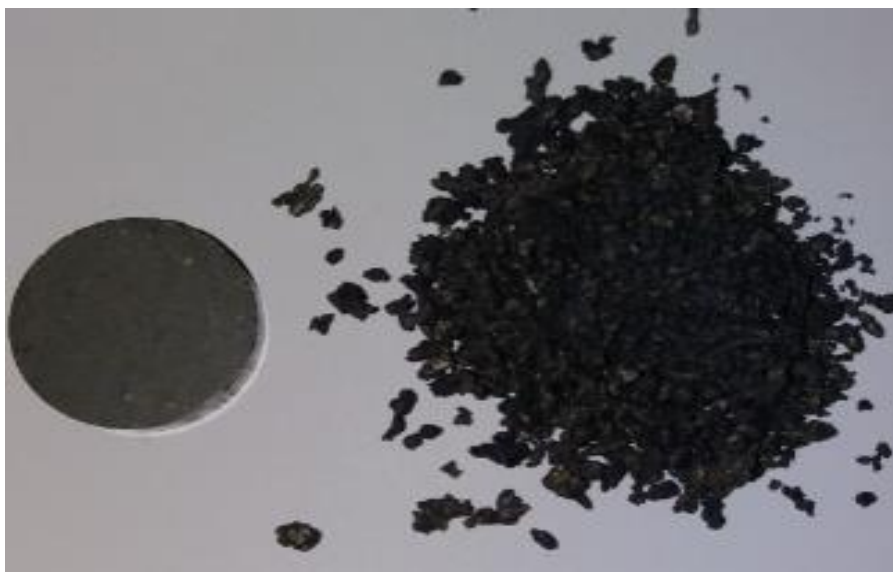
Figura 3.14. Fragilización de la mezcla de polvo de plomo y nitruro de boro (BN) [Fuente: propia]
