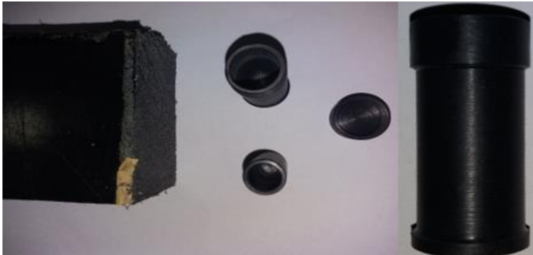
Figura 3.7. Barra de polietileno borado y contenedor cilíndrico, fabricado según diseño [Fuente: propia]
