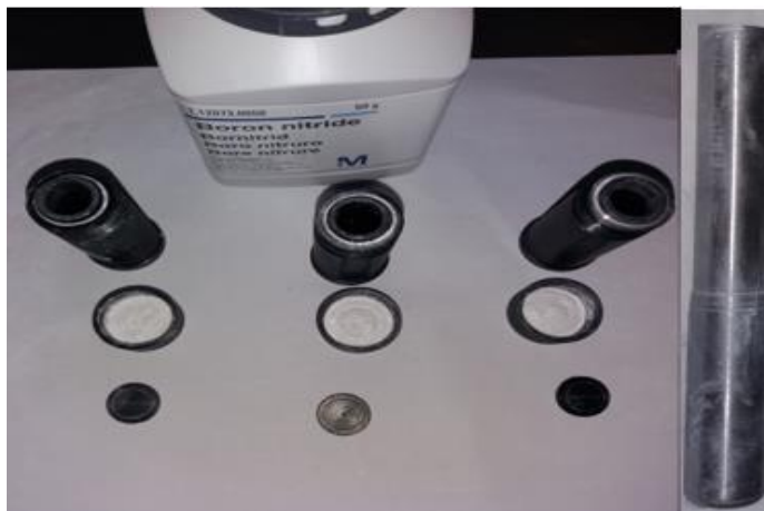
Figura 3.12 Filtros de BN cilíndrico con silicona líquida de 2mm de espesor [Fuente: propia]
