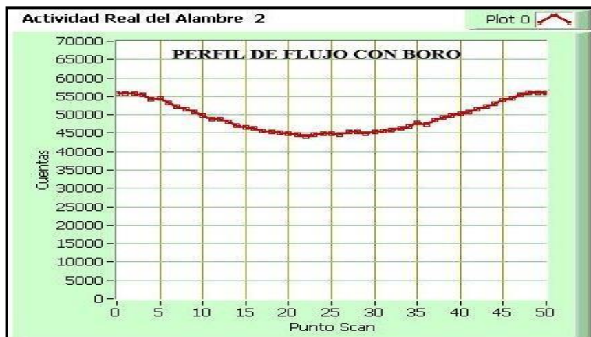
Figura 4.3 Distribución de flujo axial en la facilidad de irradiación con boro [Fuente: RENU]
