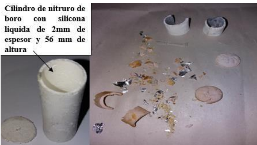
Figura 3.13. Fragilización de la mezcla de nitruro de boro con silicona líquida [Fuente: propia]
