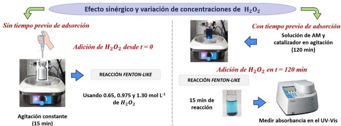
Figura 42: Sistemas Fenton-like variando concentraciones de H 2 O 2 (con y sin tiempo previo de adsorción).
