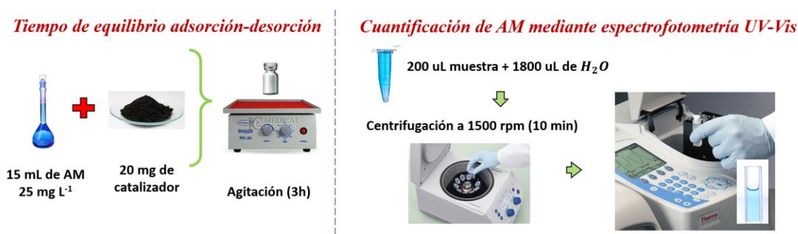
Figura 40: Esquema experimental para la determinación del tiempo de equilibrio adsorción-desorción y la cuantificación de AM mediante espectrofotometría UV-Vis.
