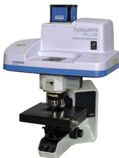
Figura 29: Microscopio Raman para análisis estructurales.
