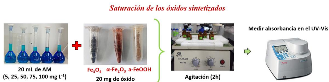
Figura 41: Organizador visual del experimento para la evaluación de la saturación de los óxidos sintéticos variando la concentración de AM (5, 25, 50, 75 y 100 mg L -1 ).
