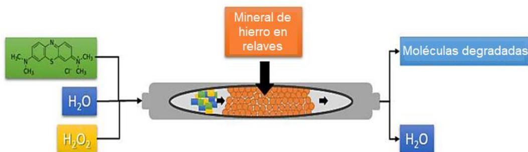
Figura 9: Representación del sistema de flujo continuo para la oxidación del azul de metileno usando como catalizador relaves del mineral hierro (de Freitas et al., 2019).
