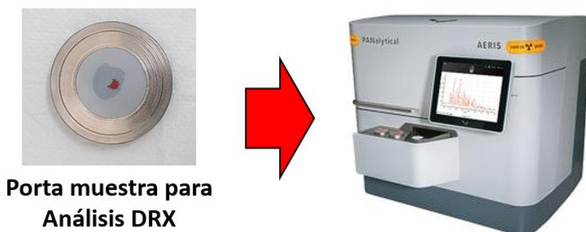
Figura 28: Porta muestra y equipo para el análisis de Difracción de Rayos X.
