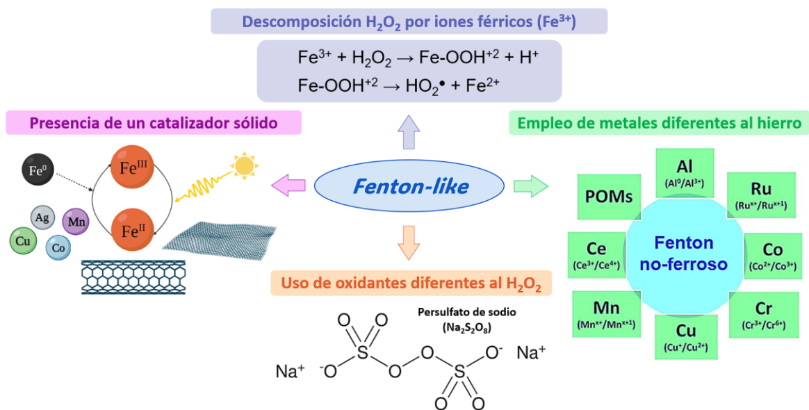
Figura 15: Variantes en la reacción Fenton tradicional que generan procesos Fenton-like.
