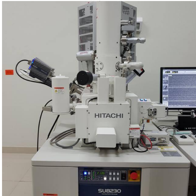
Figura 25: Fotografía del equipo de análisis SEM-EDS (Hitachi SU-8230).
