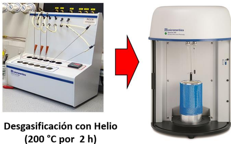
Figura 32: Equipo de fisisorción de N_2 y desgasificación de muestras.
