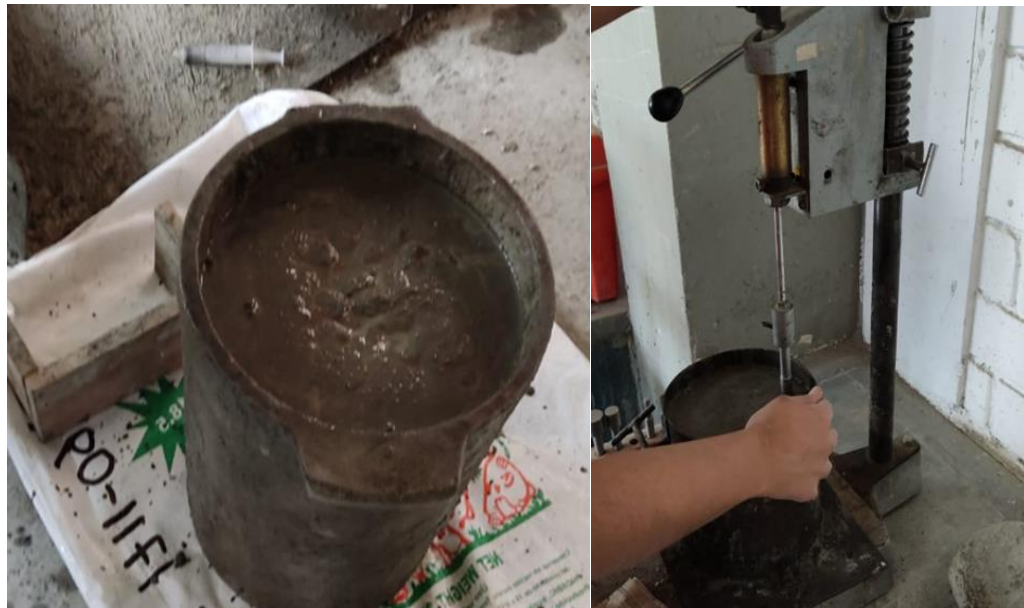
Ensayo de exudación y tiempo de fragua.
