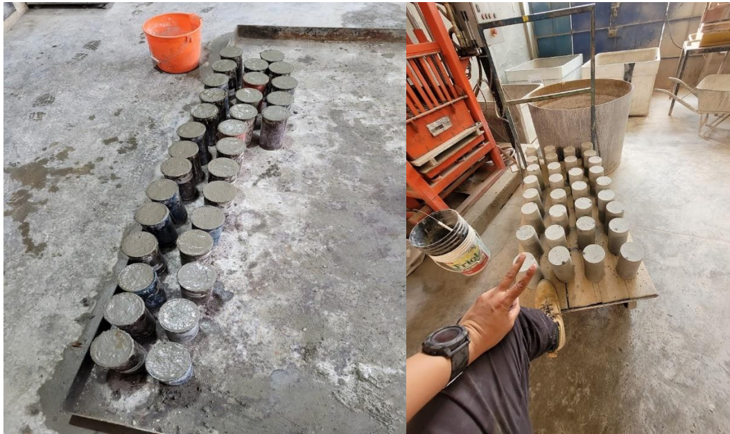
Vaciado y desmoldado de muestras de concreto.
