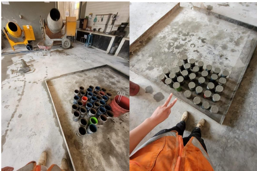
Elaboración de probetas de concreto.
