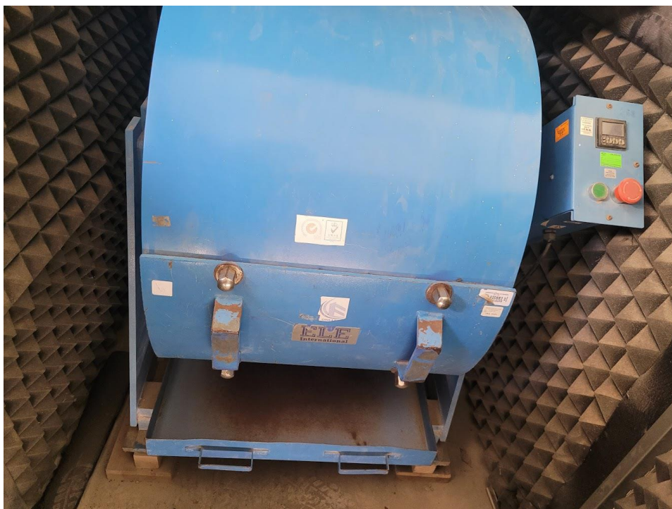
Máquina de los ángeles para ensayo de abrasión.
