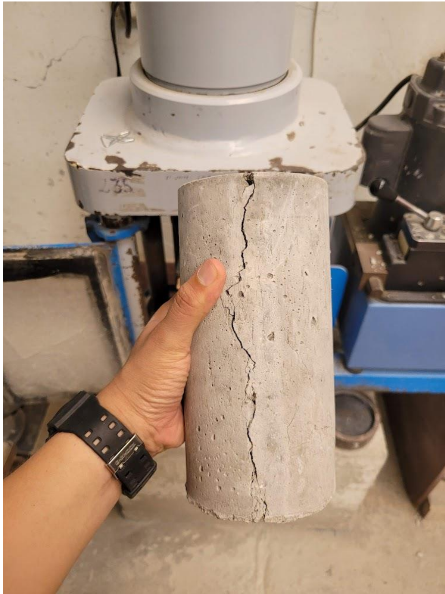
Rotura por compresión diametral.
