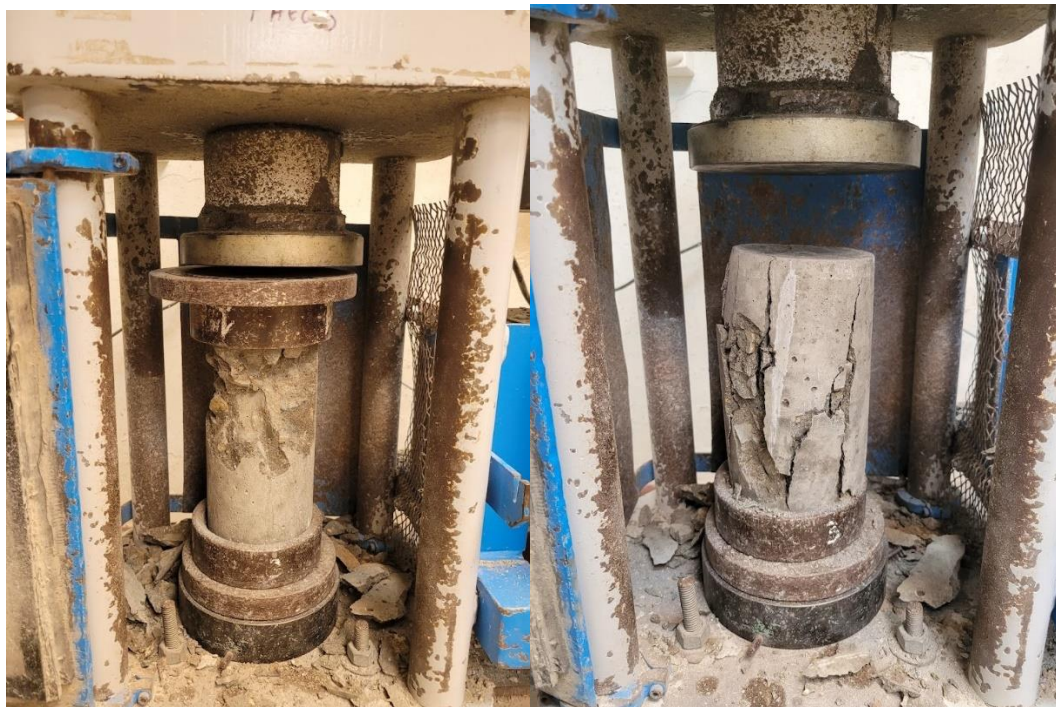
Rotura de probetas a compresión.
