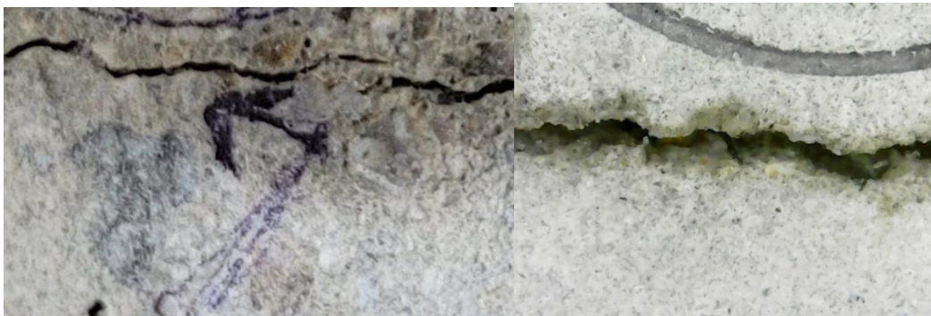
Evaluación de la fisura 1(B) – a/c = 0.50
