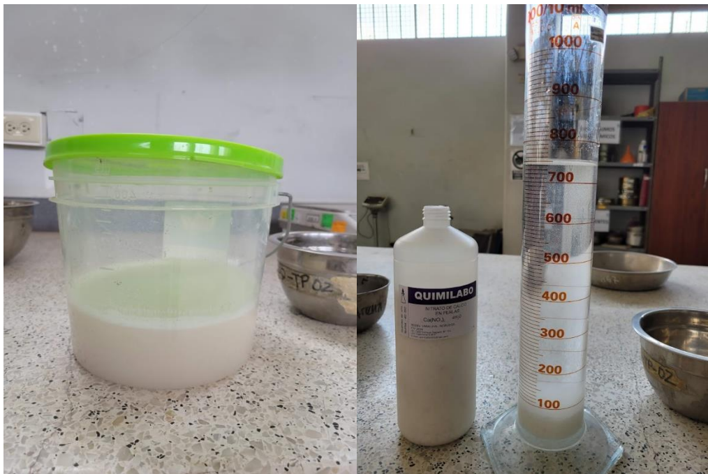
Medición del PE del nitrato de calcio en perlas y preparado de solución.
