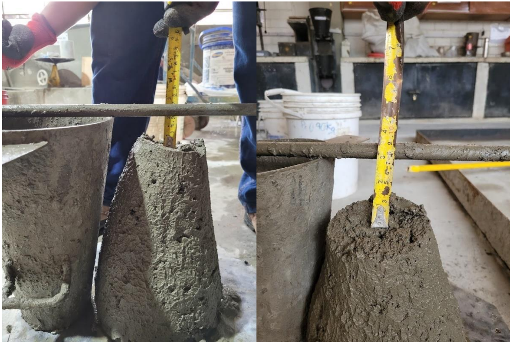
Medida del slump.
