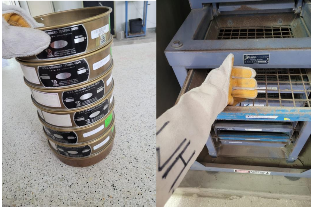
Tamices utilizados para análisis granulométrico del agregado fino y agregado grueso.
