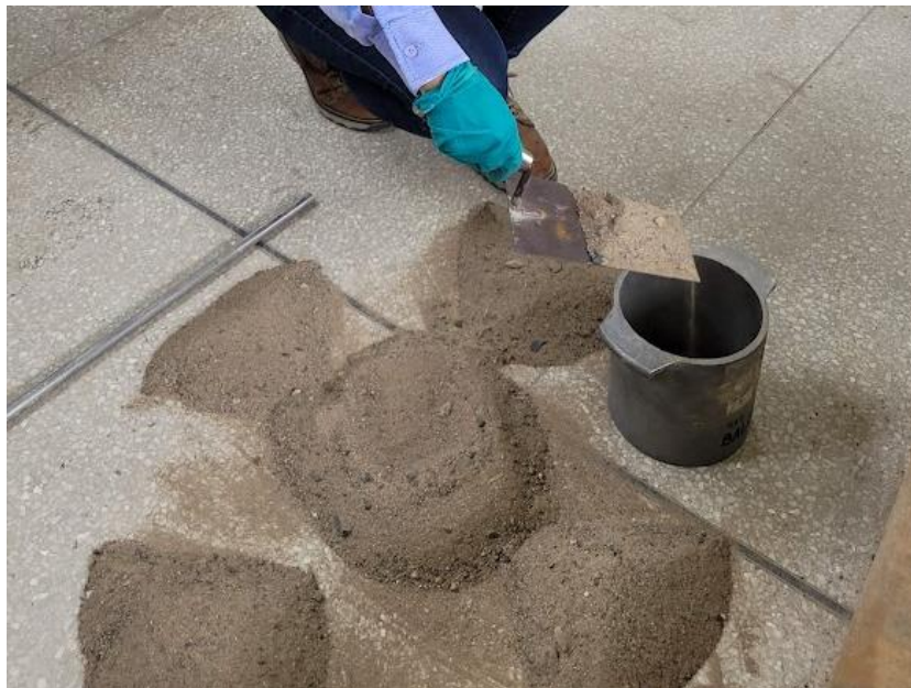
Cuarteo de la piedra y arena de la cantera Difamás.
