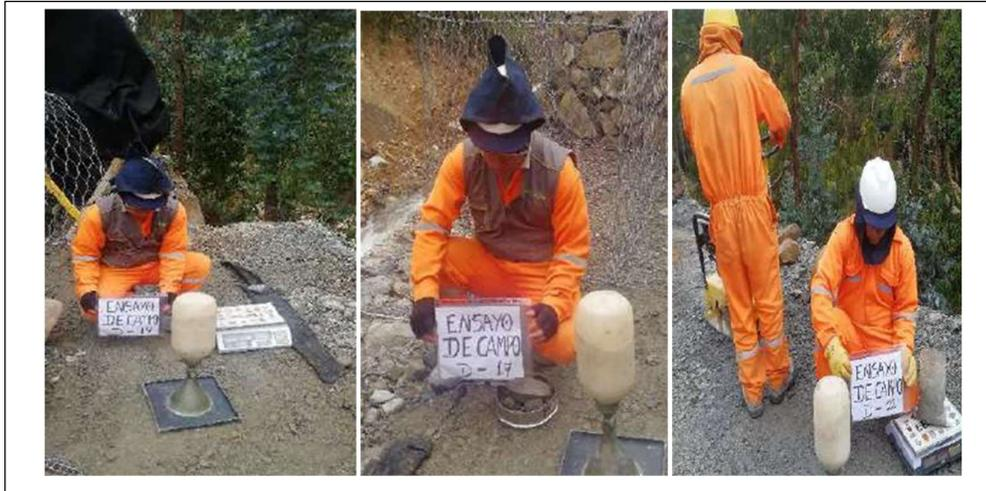
Figura N°7.1: Ensayos de campo – Prueba de densidad
