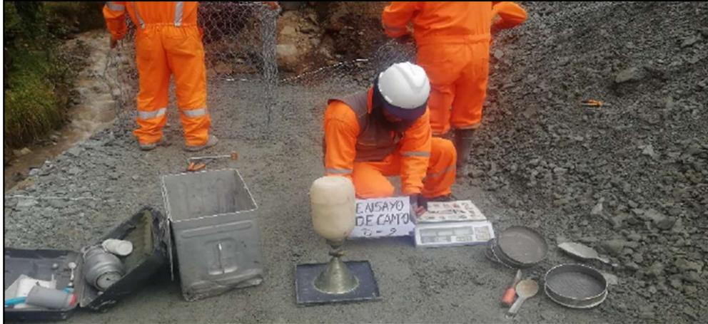
Figura N°5.23: Ensayo de campo – Densidad de campo – Método del cono de arena
