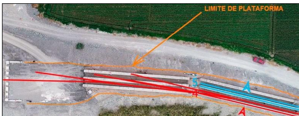
Esquema de lanzamiento de Viga N°4 con 3 giros.
