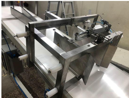
Figura 6.2 - Sistema de distribución de panetones por accionamiento neumático
