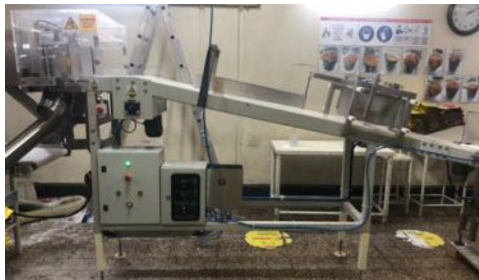
Figura 6.1 - Transportador de distribución neumática de panetones
