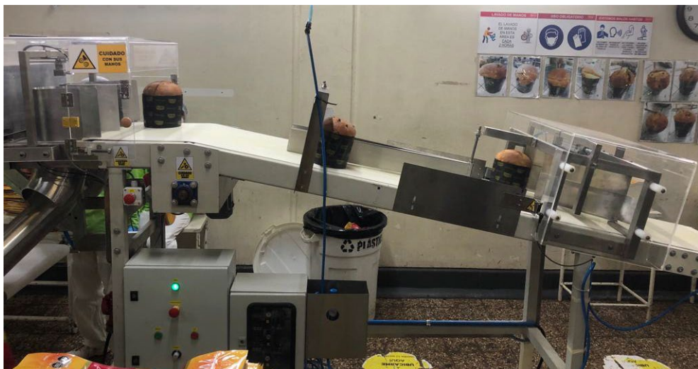
Figura 6.4 - Prueba de control de calidad de operatividad de transportador
