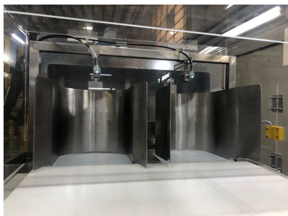
Figura 6.3 - Sistema de descarga de panetones por accionamiento neumático
