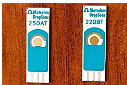
Fig. 5.37: Partes del Electrodo Serigrafiado de Oro
