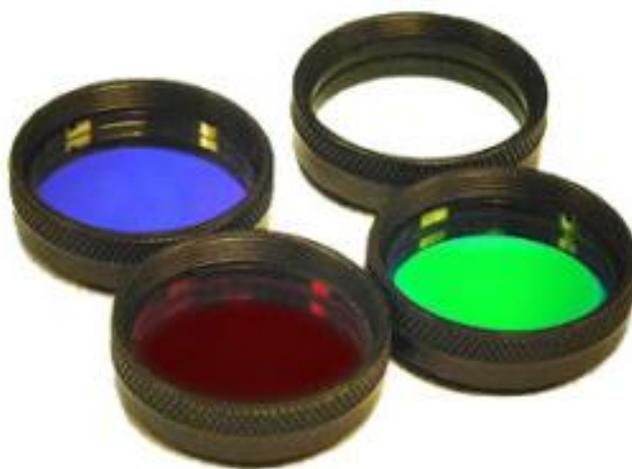
Figura 10. Filtros Ópticos en diferentes bandas
