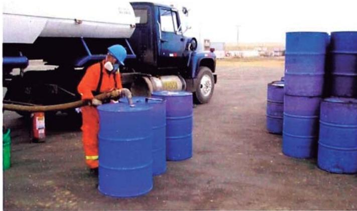
*Figura N° 13: Descarga de Cisterna a Cilindros*
