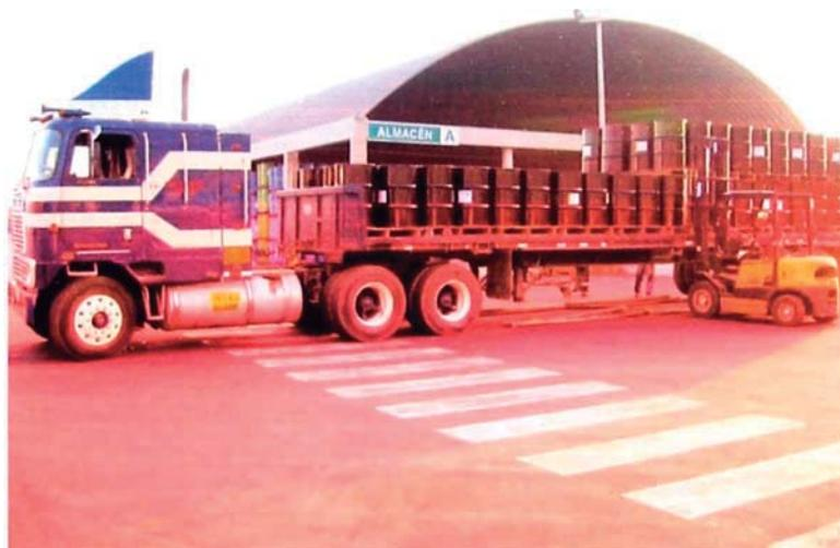
*Figura Nº 15: Carguío de Cilindros en camiones*
