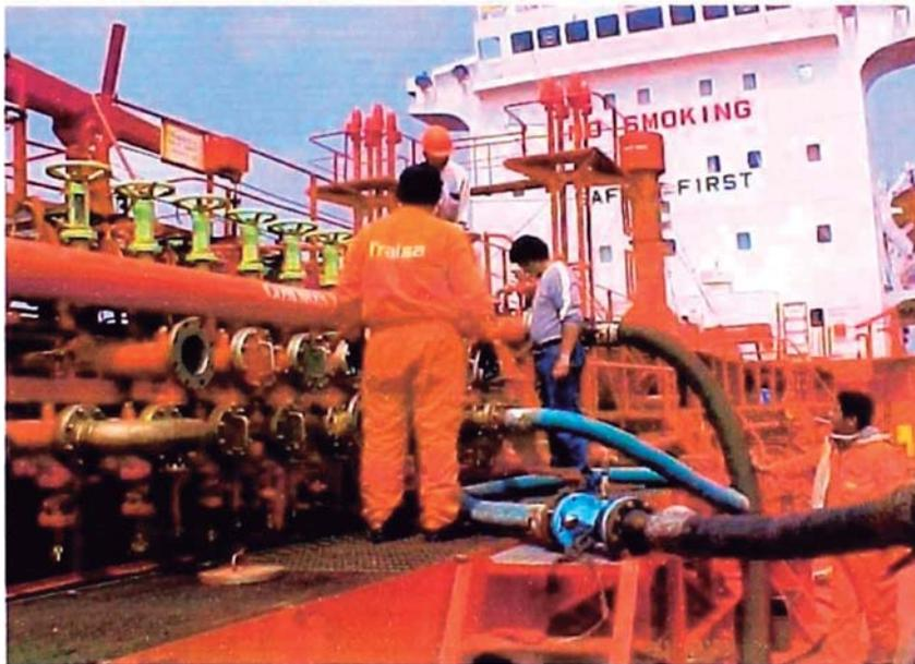
*Figura N° 10: Descarga de Buque a Tanques*
