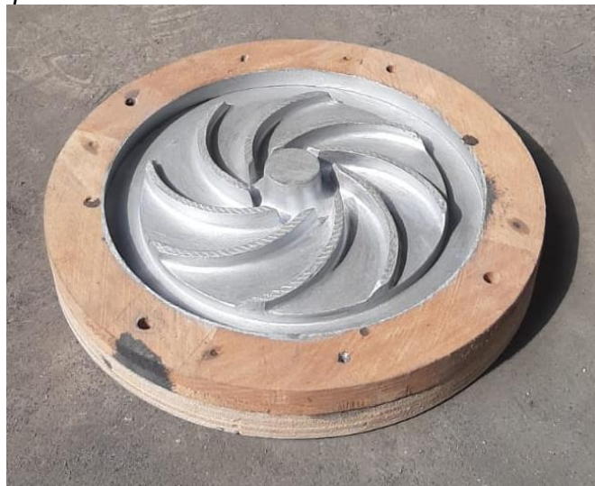
Caja de alma del impulsor de bomba
