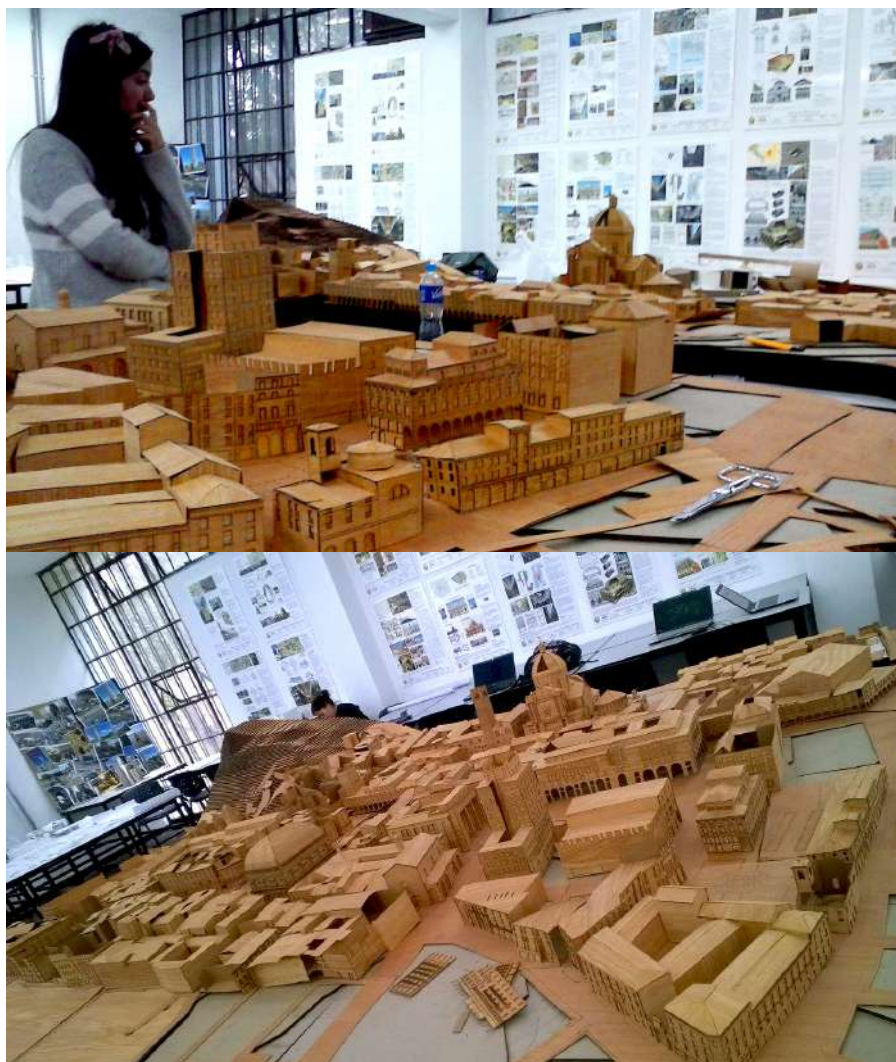
Proceso de elaboración de la maqueta. Se hicieron las fachadas en grabado láser en planchadas de madera de cedro. Al fondo, la nueva catedral de Brescia, elaborada por Cristhian García (2015)
