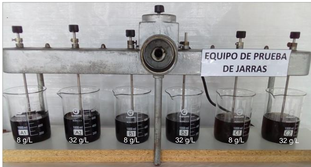
Figura 14: Pruebas de jarras para la selección del carbón activado
