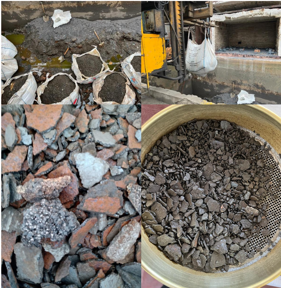
Cascarillas de acero en la poza de almacenamiento
