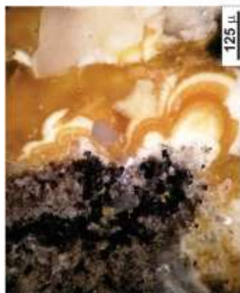
Esfalerita parda clara coliforme intercrecida con dolomita y cuarzo. LR-NX. (Manto Finlandia-DS-FI-01).
