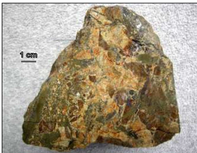
Figura 2.17. Vista de la brecha de sulfuros en la que se aprecian diversos tonos de color en la esfalerita, del manto Maracaibo Fuente: Elaboración propia.
